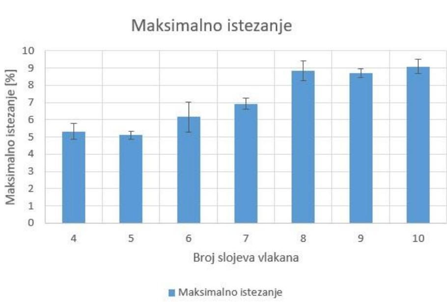
**Slika 25.** Grafički prikaz promjene maksimalnog istezanja u ovisnosti o broju slojeva vlakana u kompozitu kod rasteznog ispitivanja
