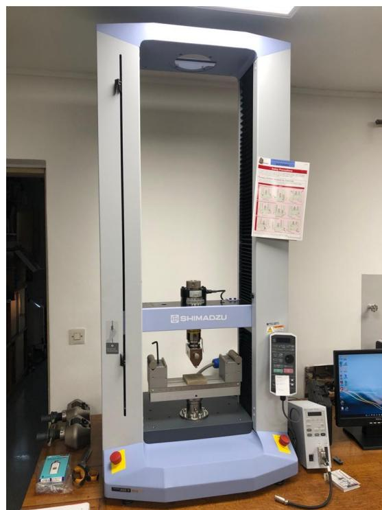
**Slika 11. Kidalica Shimadzu AGS-X**
