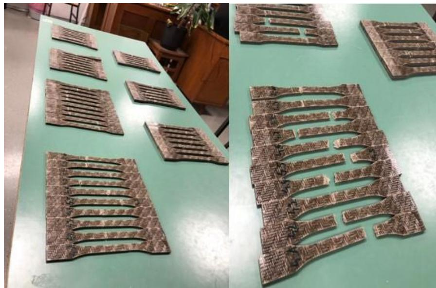
**Slika 16. Uzorci nakon provedenog rasteznog ispitivanja**
