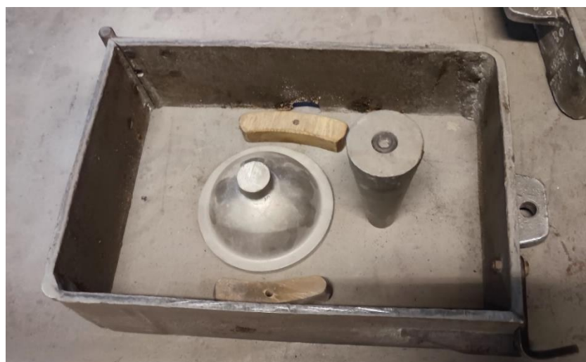
Slika 41. Položaj uljevnog sustava
