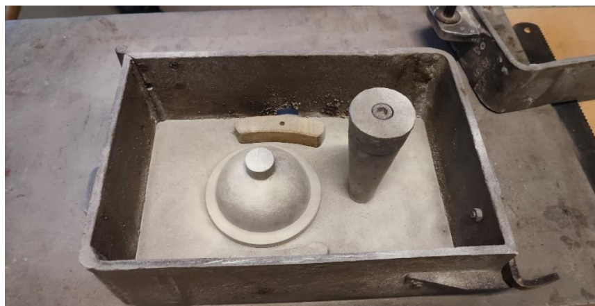
Slika 42. Model i uljevni sustav posipani sredstvom za razdvajanje
