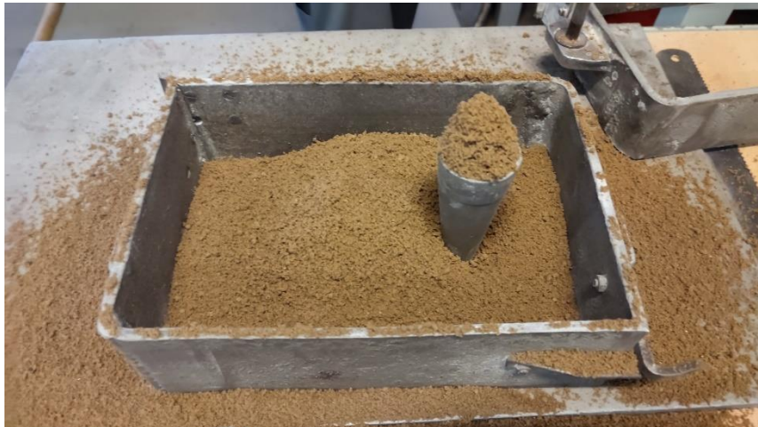
Slika 43. Stavljanje modelne kalupne mješavine
