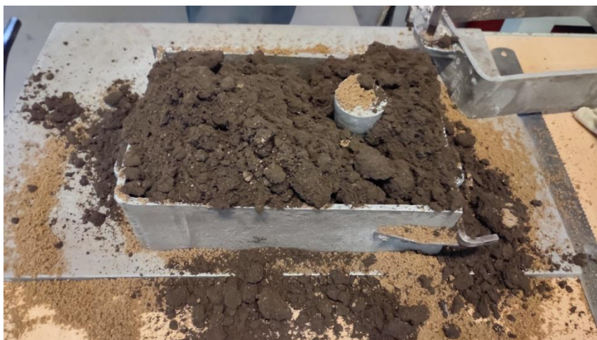
Slika 44. Stavljanje punidbene kalupne mješavine
