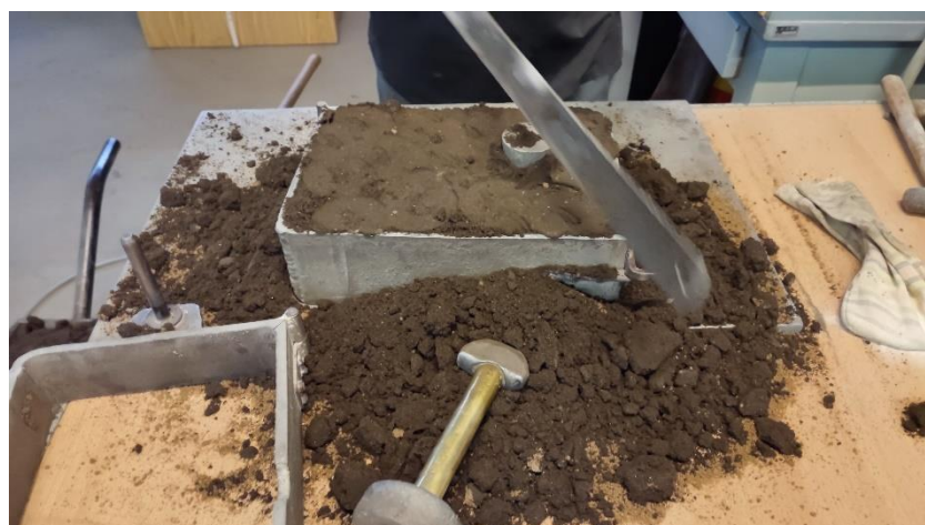
Slika 45. Poravnavanje kalupne mješavine
