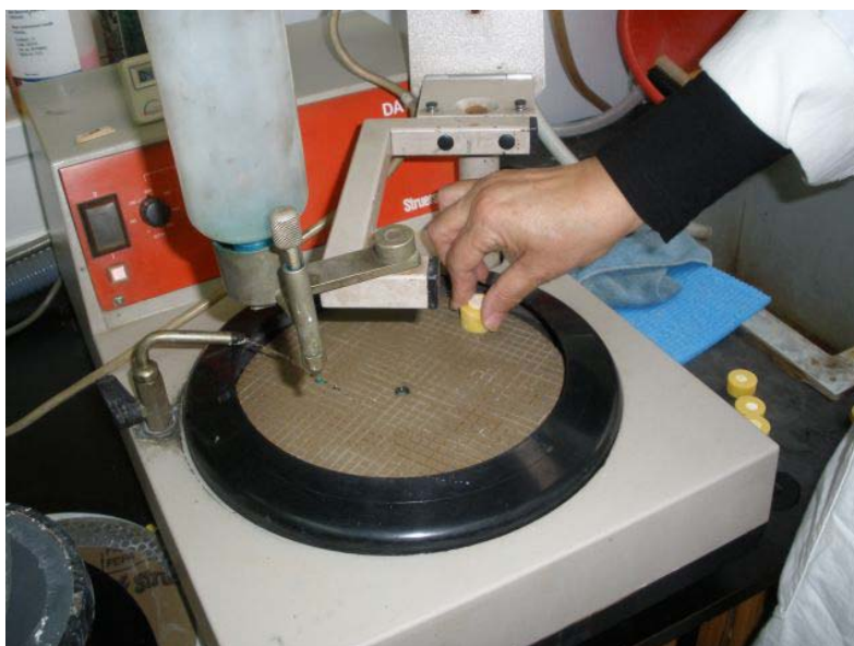
Slika 12. Brušenje uzorka na uređaju DAP-W STRUERS
