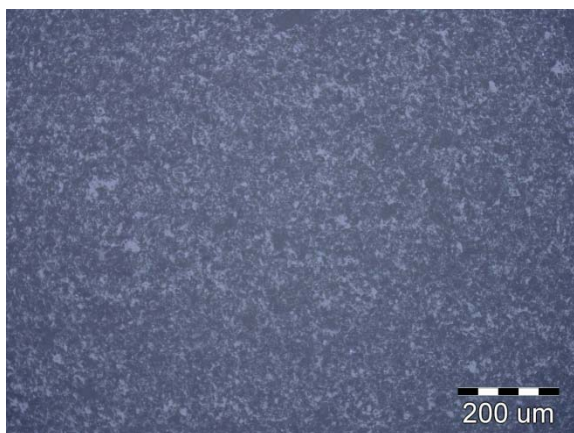
Slika 14a. Površina uzorka nakon 3. faze brušenja
