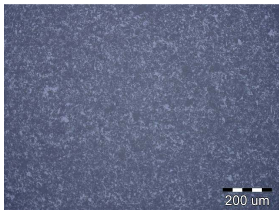
Slika 14a. Površina uzorka nakon 3. faze brušenja
