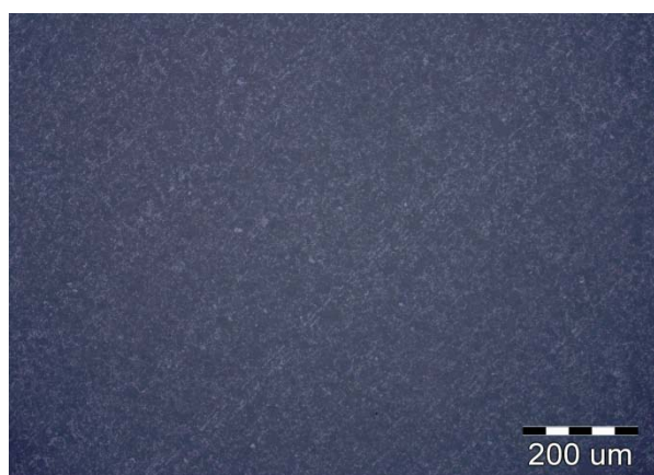
Slika 13a. Površina uzorka nakon 1. faze brušenja
