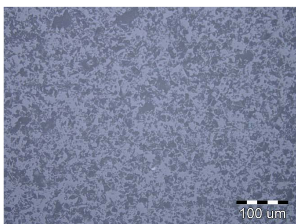
Slika 16a. Površina nakon 1. stupnja poliranja
