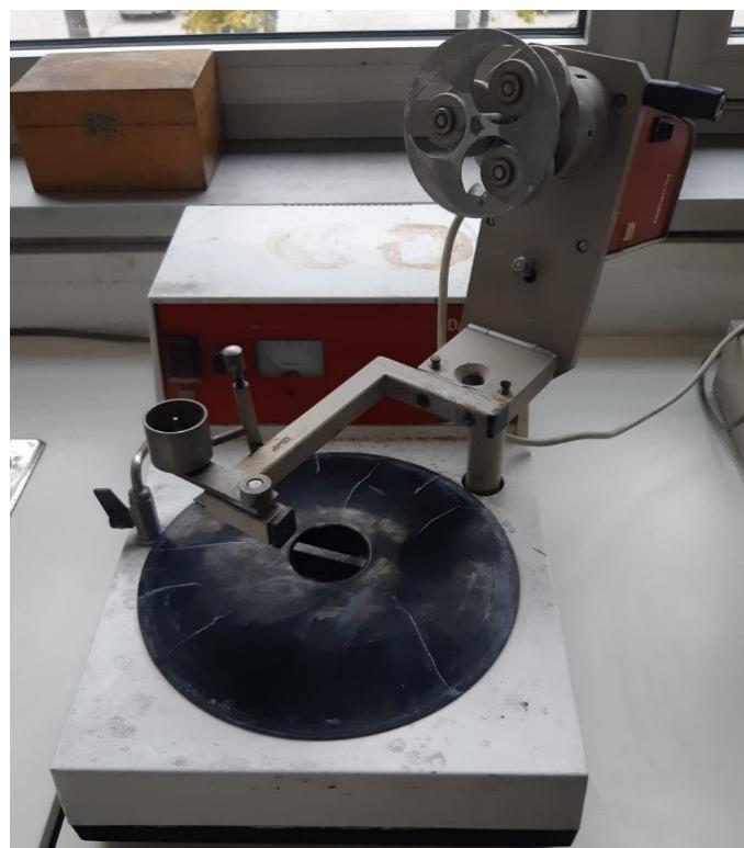
Slika 28. Uređaj za poliranje Struers DAP-V
