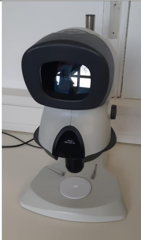
Slika 16. Stereo mikroskop Mantis Elite-Cam HD
