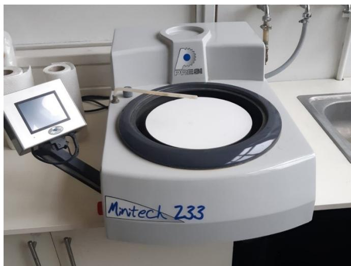
Slika 27. Uređaj za brušenje Presi Minitech 233
