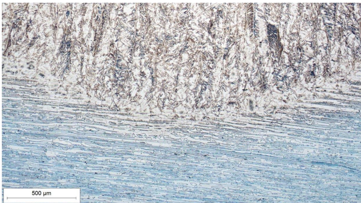
Slika 42. Mikrostruktura korijena navara uzorka 1B uz povećanje 50x
