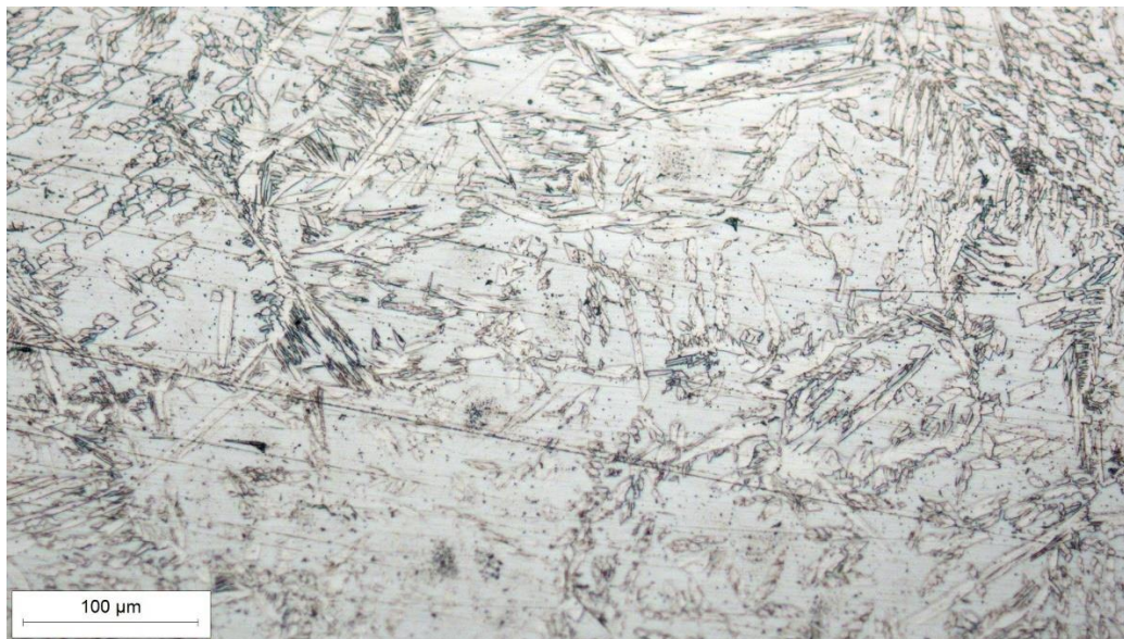
Slika 38. Mikrostruktura navara uzorka 1B uz povećanje 200x
