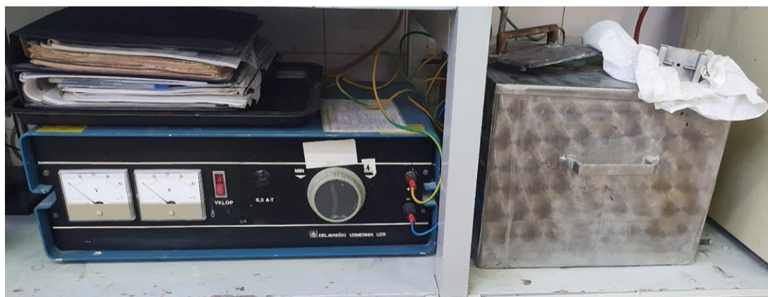
Slika 26. Oprema za elektrokemijsko nagrizanje uzoraka
