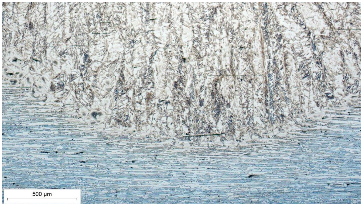
Slika 41. Mikrostruktura korijena navara uzorka 1A uz povećanje 50x
