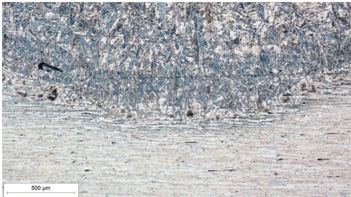
Slika 43. Mikrostruktura korijena navara uzorka 2A uz povećanje 50x
