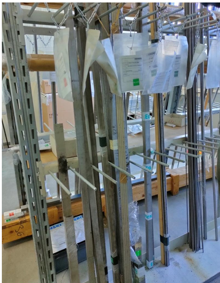
Slika 26. Skladištenje ravnih šipki legure titana
