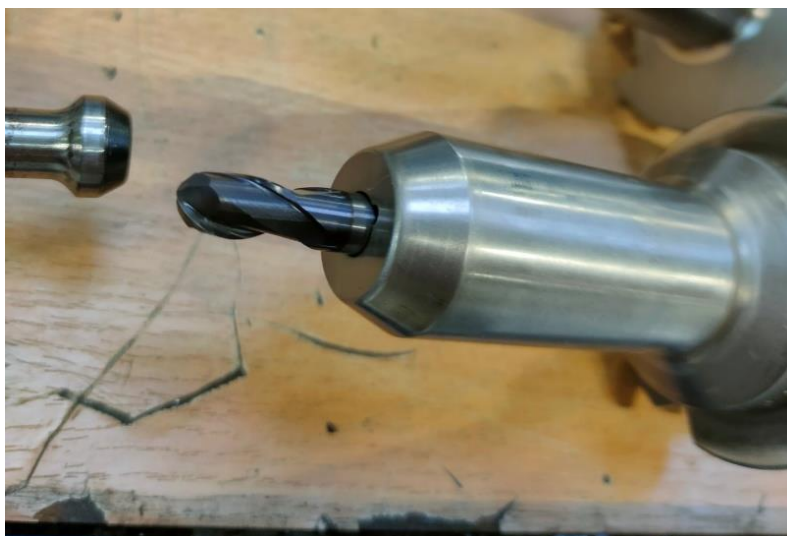
Slika 32. Kuglasto glodalo Ø10
