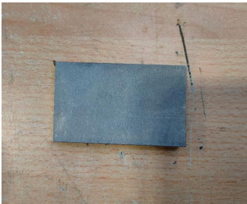
Slika 25. Oblik sirovca nakon piljenja
