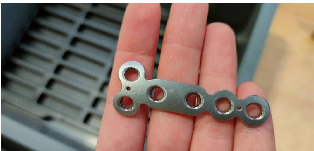
Slika 34. Izgled pločice nakon strojne obrade
