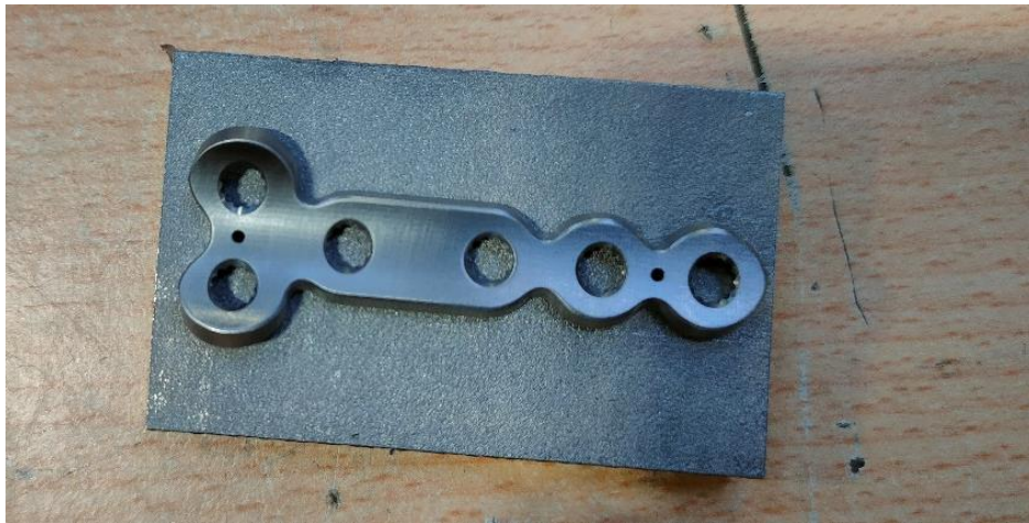
Slika 35. Usporedba izgleda sirovca i izratka pločice
