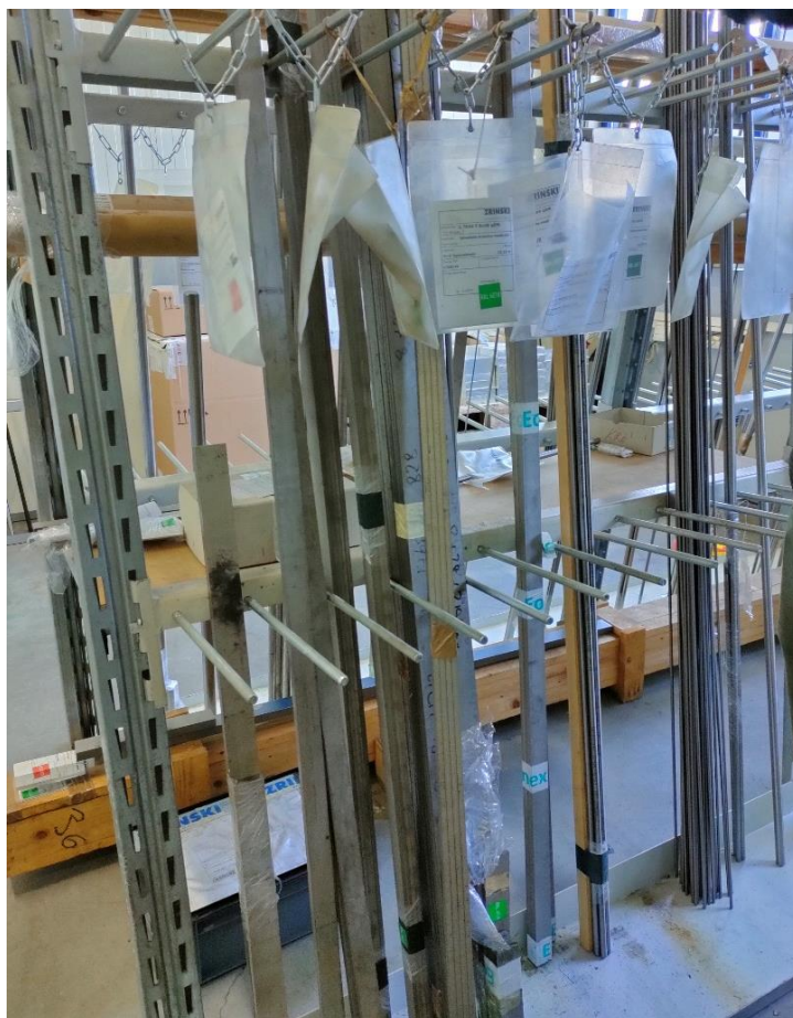
Slika 26. Skladištenje ravnih šipki legure titana
