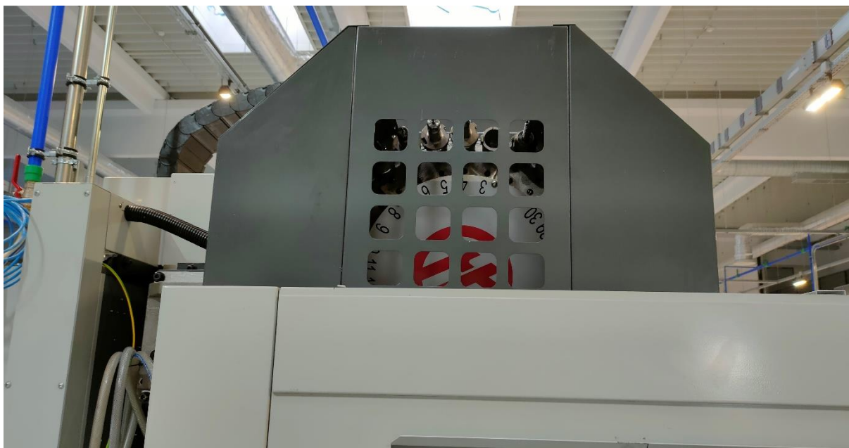
Slika 18. HAAS VF-2SSYT spremište alata
