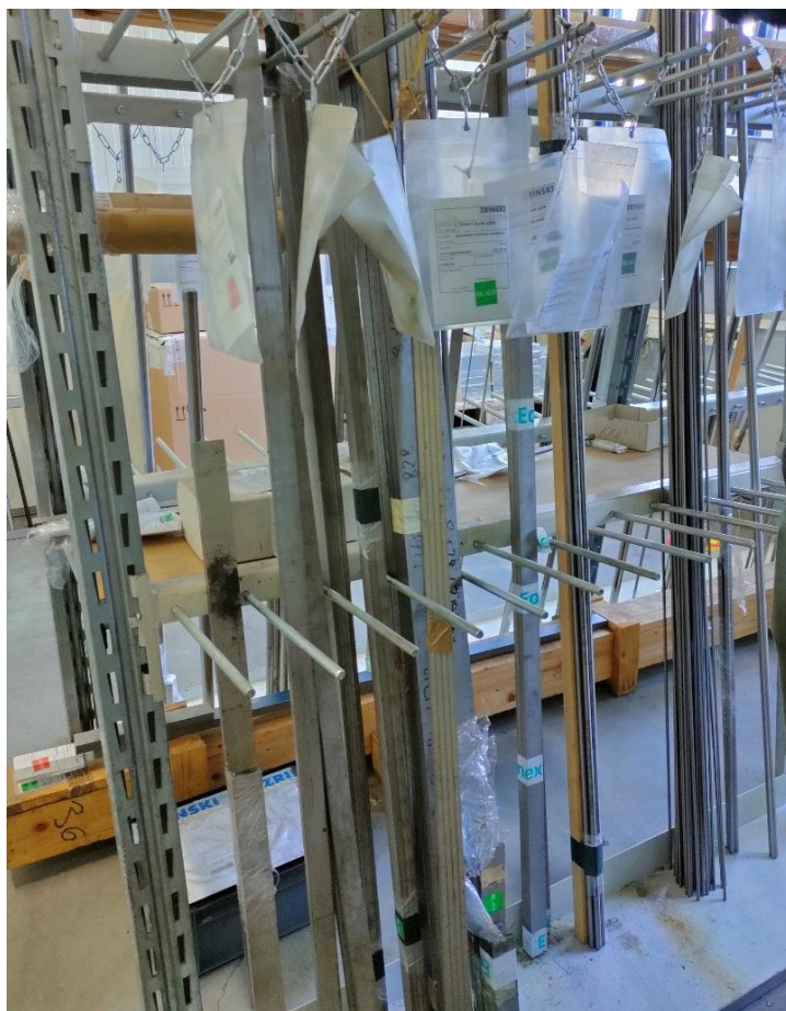
Slika 26. Skladištenje ravnih šipki legure titana
