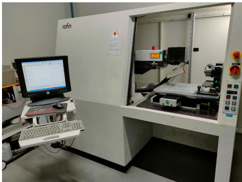
Slika 41. Uređaj za lasersko označavanje pločice
