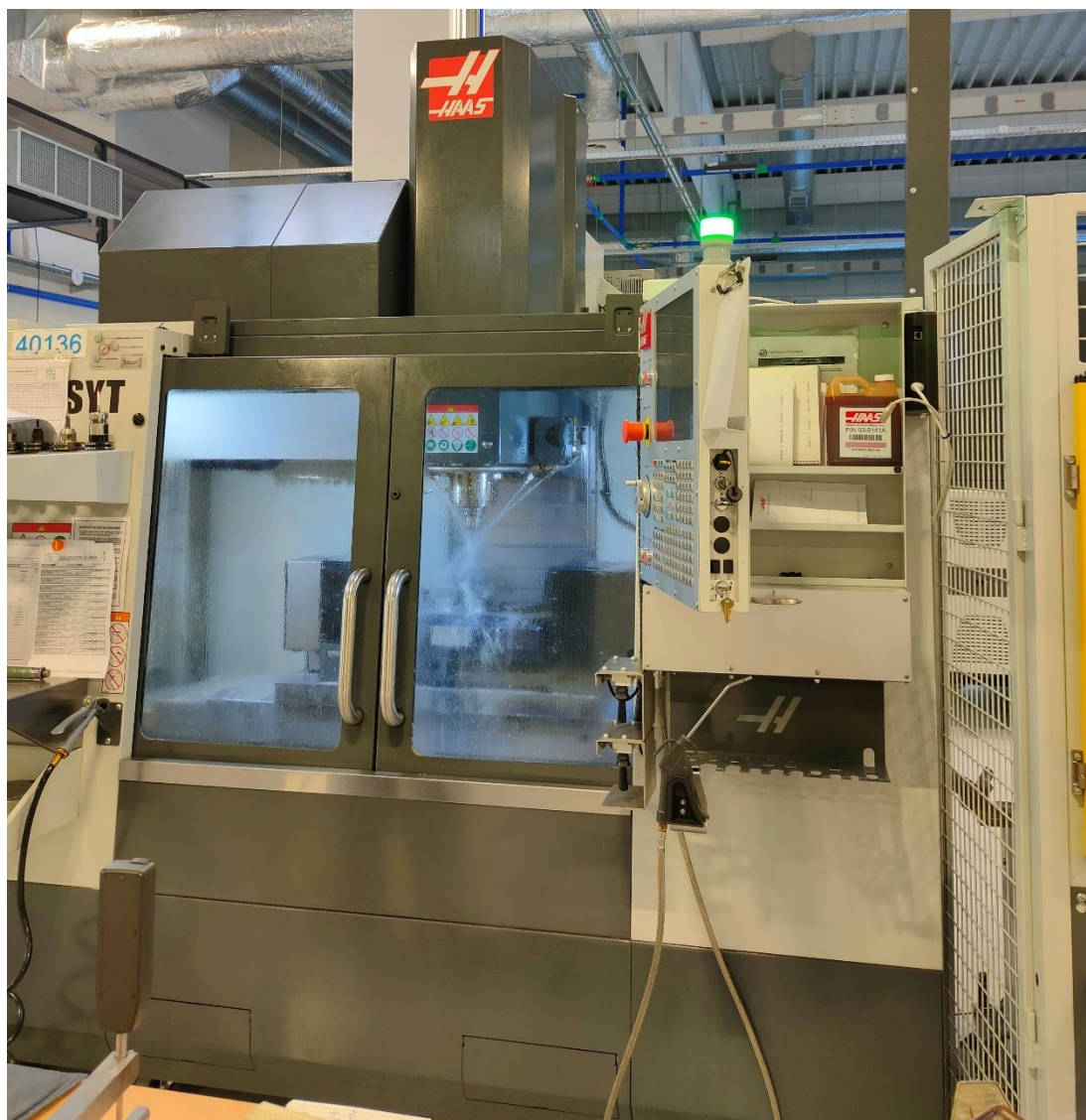
Slika 17. Glodaći obradni centar HAAS VF-2SSYT
