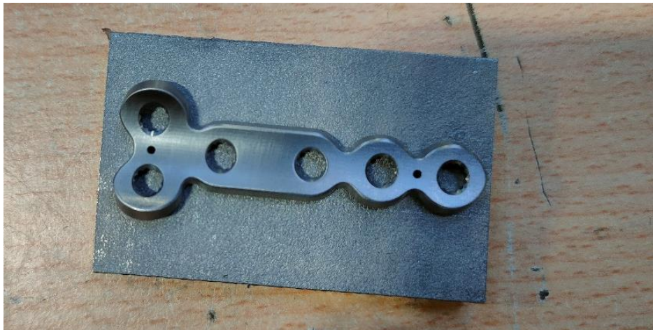
Slika 35. Usporedba izgleda sirovca i izratka pločice
