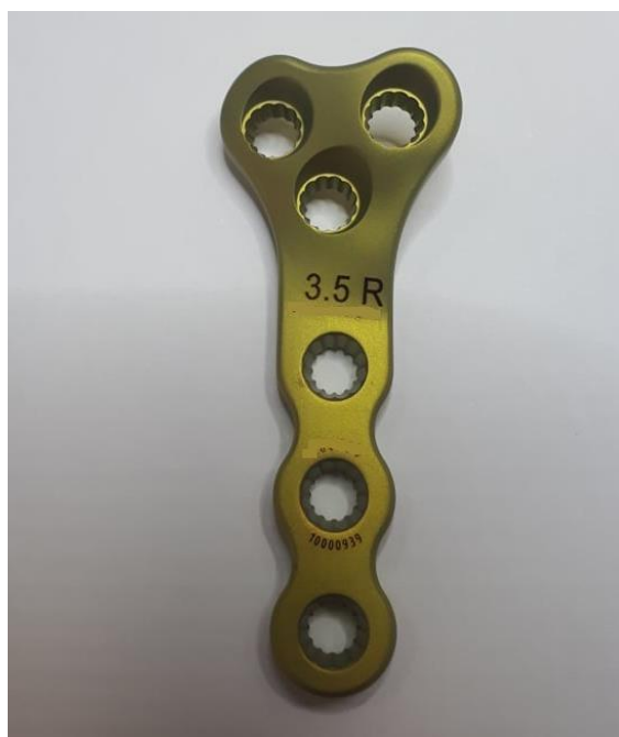
Slika 42. Konačan izgled pločice nakon završne obrade
