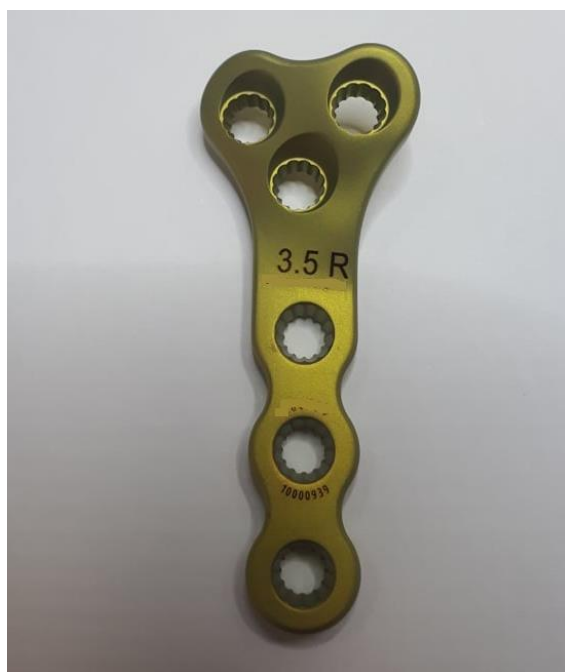
Slika 42. Konačan izgled pločice nakon završne obrade
