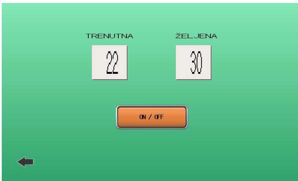
Slika 6.6. Zaslona za upravljanje RVZ
