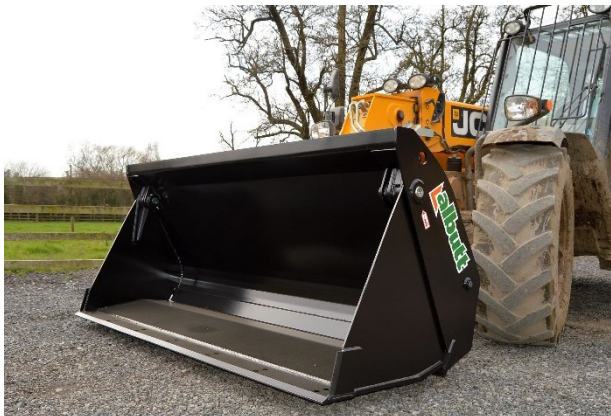
Slika 8. Zatvoreni položaj višenamjenske utovarne lopate 4 u 1 [17]
