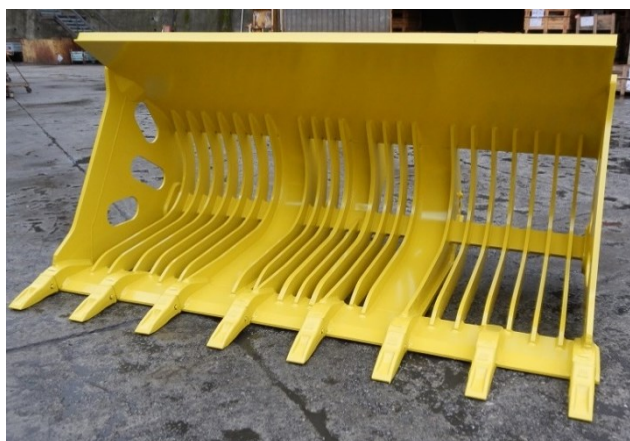
Slika 10. Utovarna lopata za kamen sa kostur struktururom[21]
