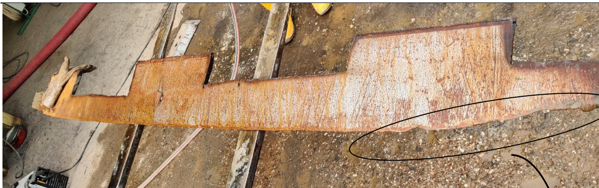
Slika 16. Potrošeni nož utovarne lopate na kojem su provedena ispitivanja
