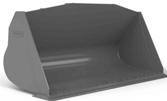
**Slika 7. Utovarna lopata opće namjene[15]**
