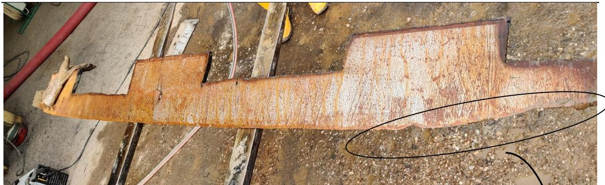
Slika 16. Potrošeni nož utovarne lopate na kojem su provedena ispitivanja
