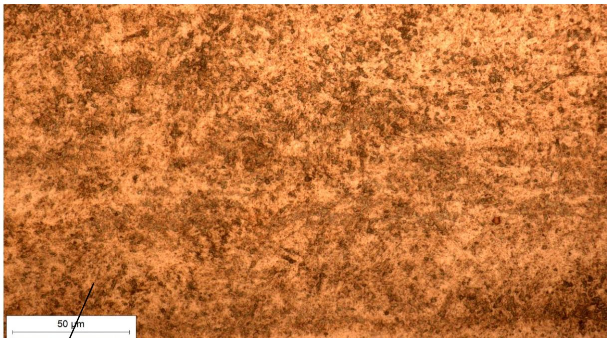
Slika 19. Mikrostruktura utovarne lopate, povećanje 500x
