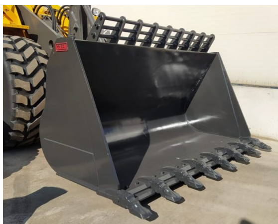
Slika 9. Utovarna lopata za kamen[20]
