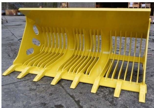
Slika 10. Utovarna lopata za kamen sa kostur struktururom[21]
