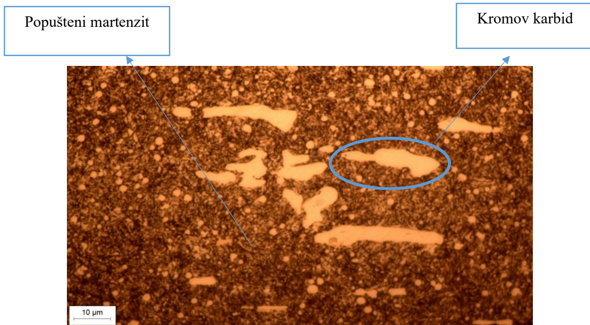
Slika 10. Mikrostruktura jezgre uzorka noža, povećanje 1000x
