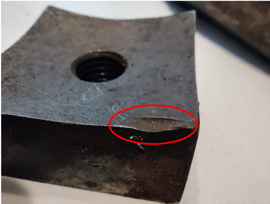
Slika 5. Umor površine vidljiv na rubu noža industrijske rezalice
