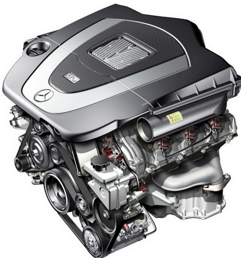
**Slika 5.64.** Mercedes-ov motor V6-90°, KV 90(+30), M272 E35 [9]
