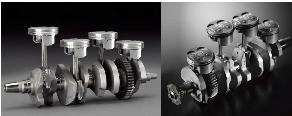
Slika 5.45. Lijevo: YZF R1 „crossplane“ radilica; Desno: konvencionalna „flatplane“ radilica [7]
