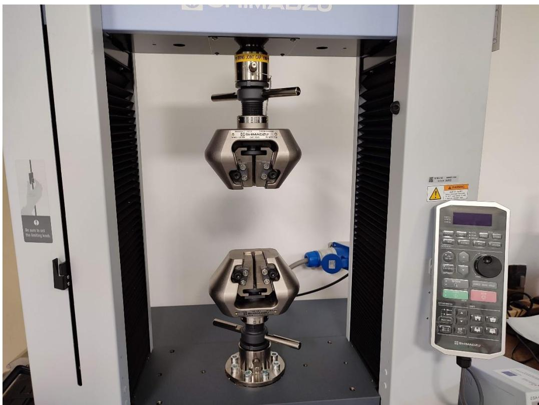
Slika 25. Kidalica za provedbu ispitivanja čvrstoće
