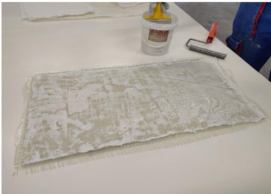
Slika 18. Nanošenje središnjeg sloja UHMWPE vlakna
