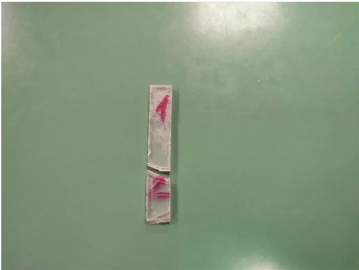
*Slika 27. Slomljena epruveta nakon ispitivanja na Charpyjevom batu*
