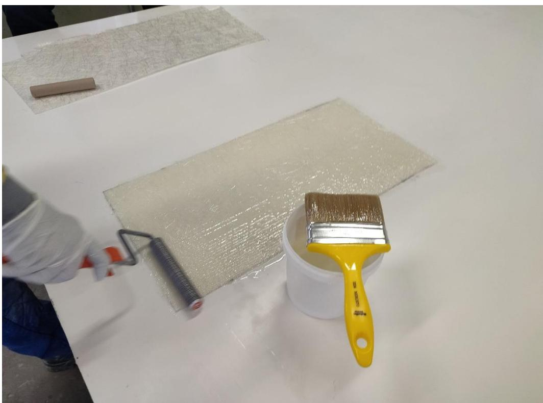
*Slika 17. Izrada ploče metodom ručnog polaganja*
