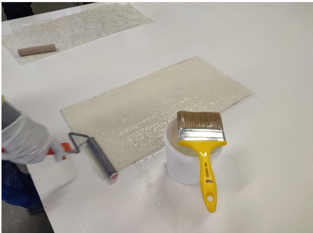
Slika 17. Izrada ploče metodom ručnog polaganja
