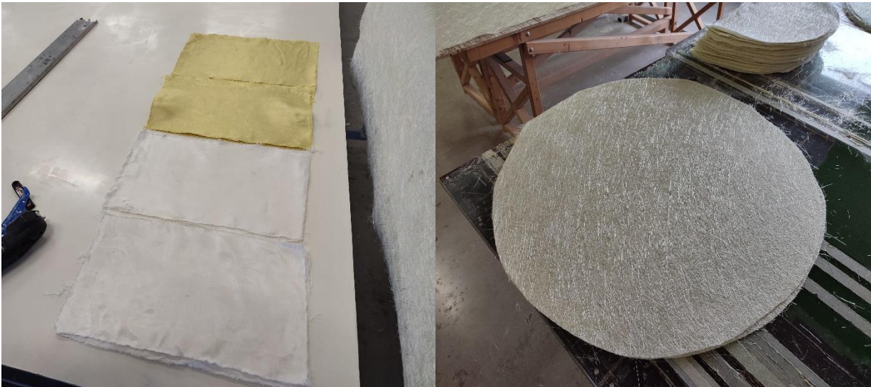
Slika 16. Slojevi UHMWPE i staklenih vlakana
