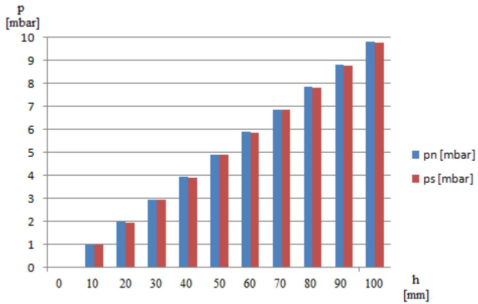
*Slika 15 - Ovisnost očitavanja na minimetru o tlaku*
