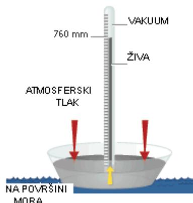
Slika 2 - Torricelliev barometar
