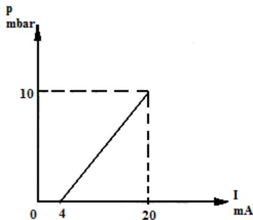
Slika 13 - Linearna ovisnost tlaka o strujnom signalu
