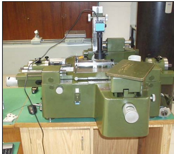
Slika 9.8 Univerzalni mjerni mikroskop s DC kamerom
