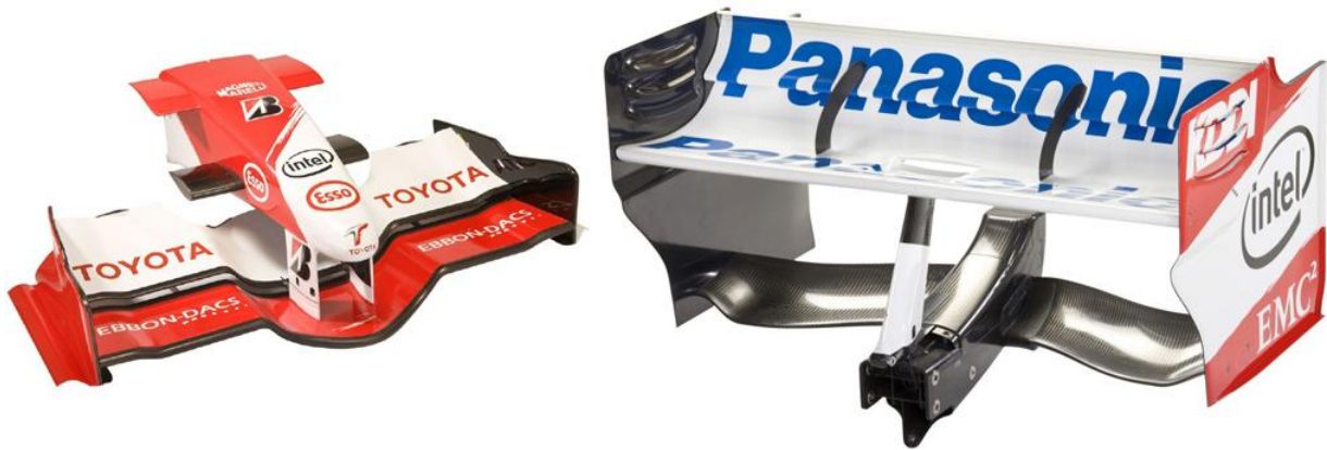
Slika 6. Prednje (lijevo) [9] i stražnje (desno) [10] krilo Formule 1
