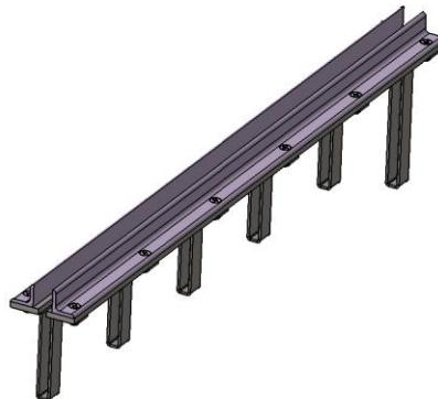
Slika 25. Sklop grede vibrododavača
