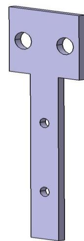
Slika 27. Prednji nosač pneumatskog cilindra
