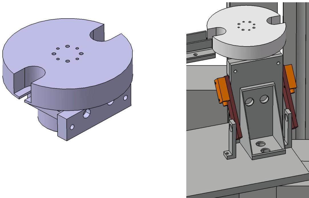
Slika 19. Mehanizam za rotiranje krivulje s osovinom
