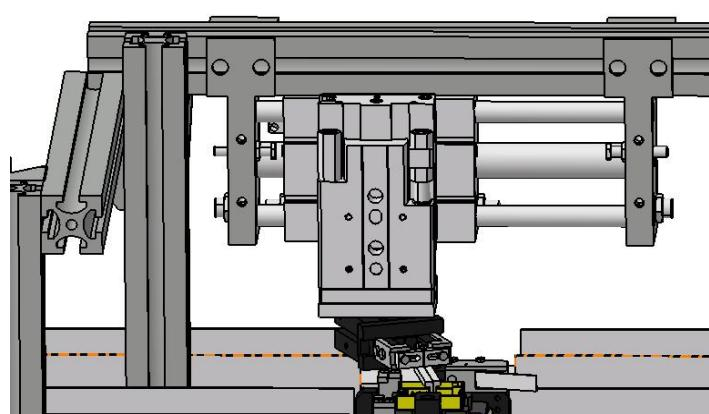
Slika 15.b) Novi mehanizam za razdvajanje kontaktnog pera
