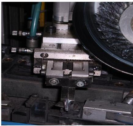
Slika 15.a) Stari mehanizam za razdvajanje kontaktnog pera
