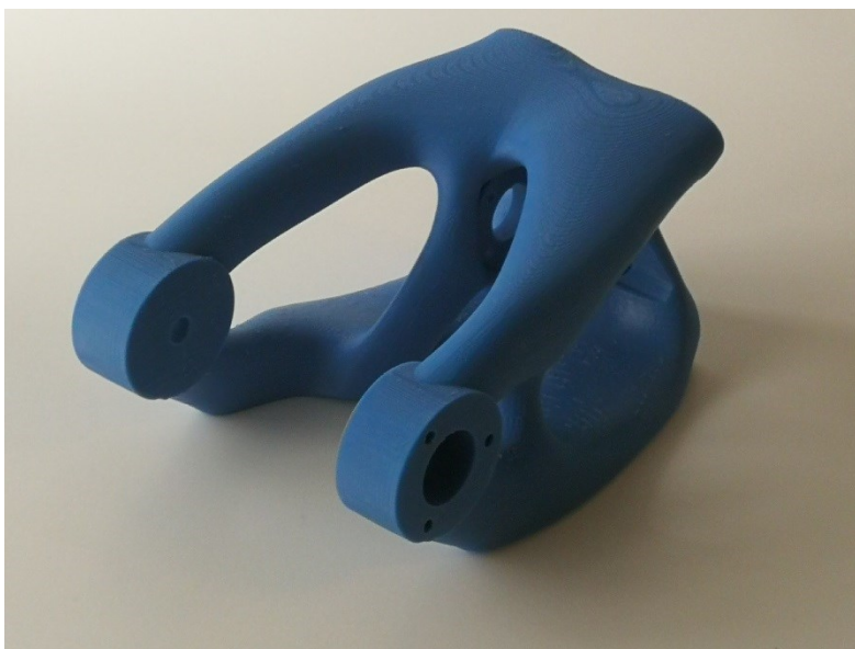
Slika 47. Proizvod nakon uklanjanja potporne strukture
