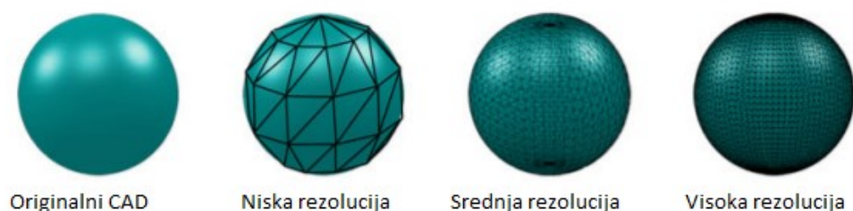
Slika 21. Usporedba rezolucija STL datoteka [14]
