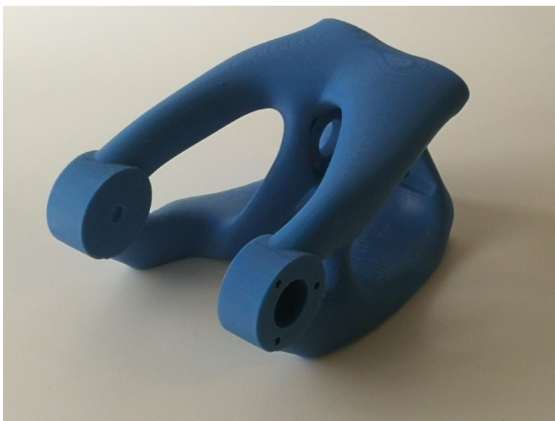
Slika 47. Proizvod nakon uklanjanja potporne strukture
