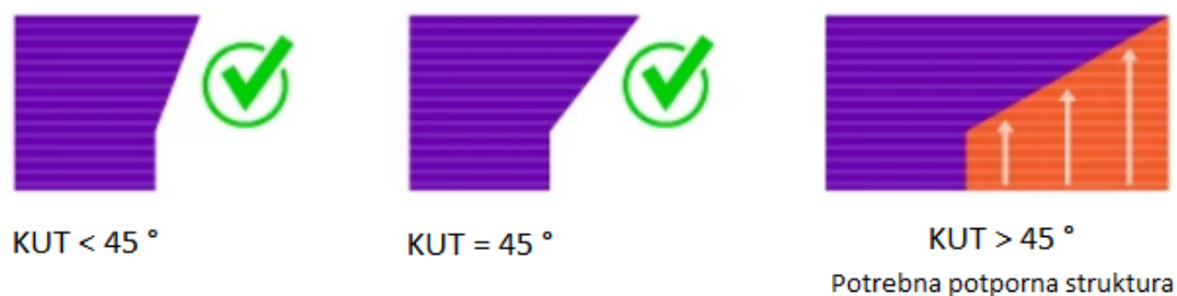
Slika 27. Samonosivi kut za aditivnu proizvodnju [20]
