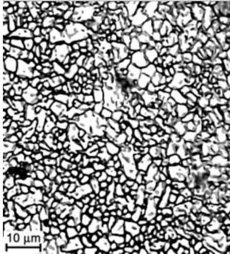
Slika 1. Mikrostruktura sitnozrnate aluminij oksidne keramike [3]
