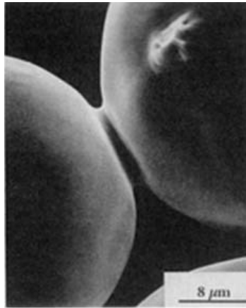
Slika 13. Stvaranje "vrata" na mjestu kontakta između čestica
