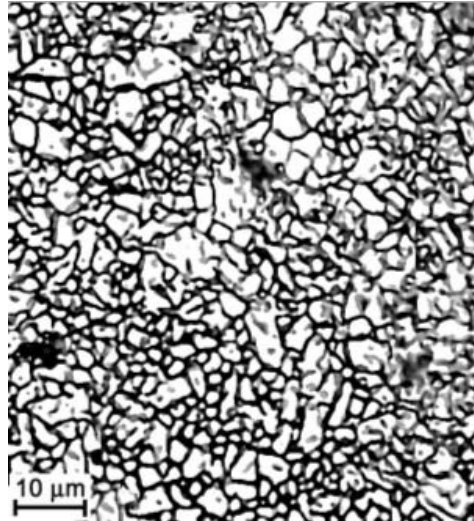
Slika 1. Mikrostruktura sitnozrnate aluminij oksidne keramike [3]
