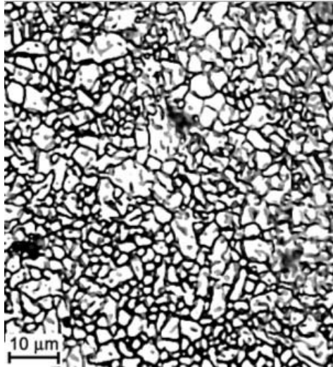
Slika 1. Mikrostruktura sitnozrnate aluminij oksidne keramike [3]
