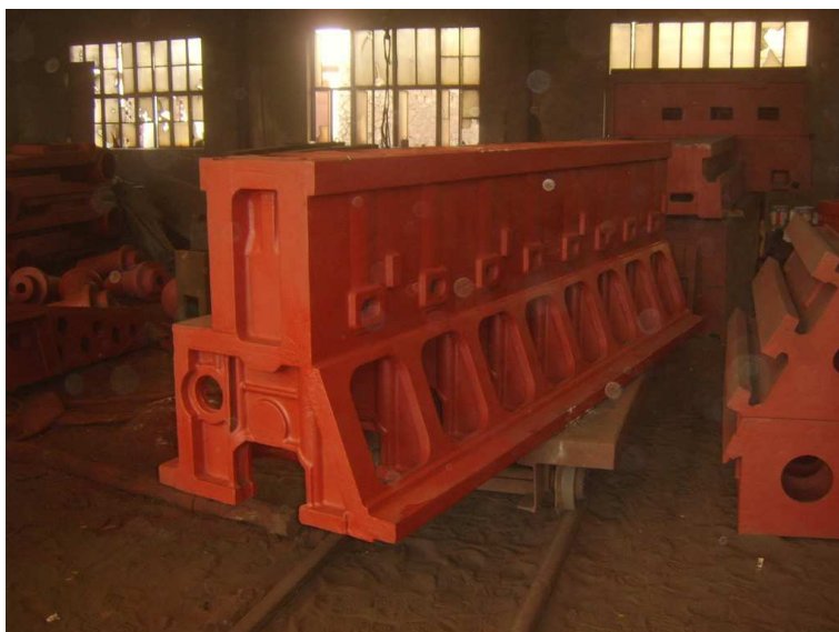
Slika 10. Blok brodskog motora [8]
