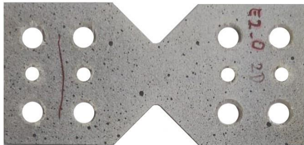
Slika 13. Ispitni uzorak s nanesenim stohastičkim crno-bijelim rasterom.
