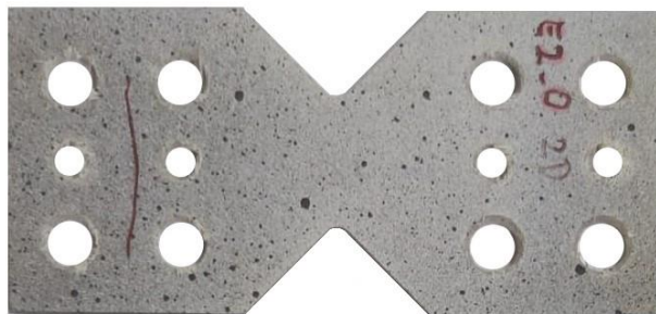
Slika 13. Ispitni uzorak s nanesenim stohastičkim crno-bijelim rasterom.
