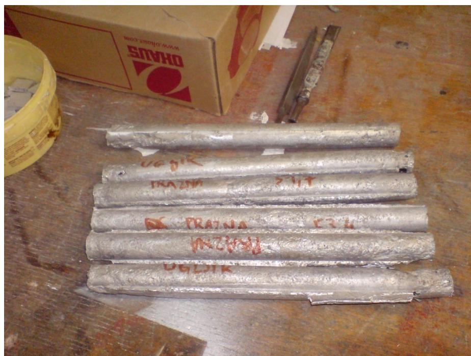
Slika 38. Gotovi ispitni uzorci aluminijске pjene
