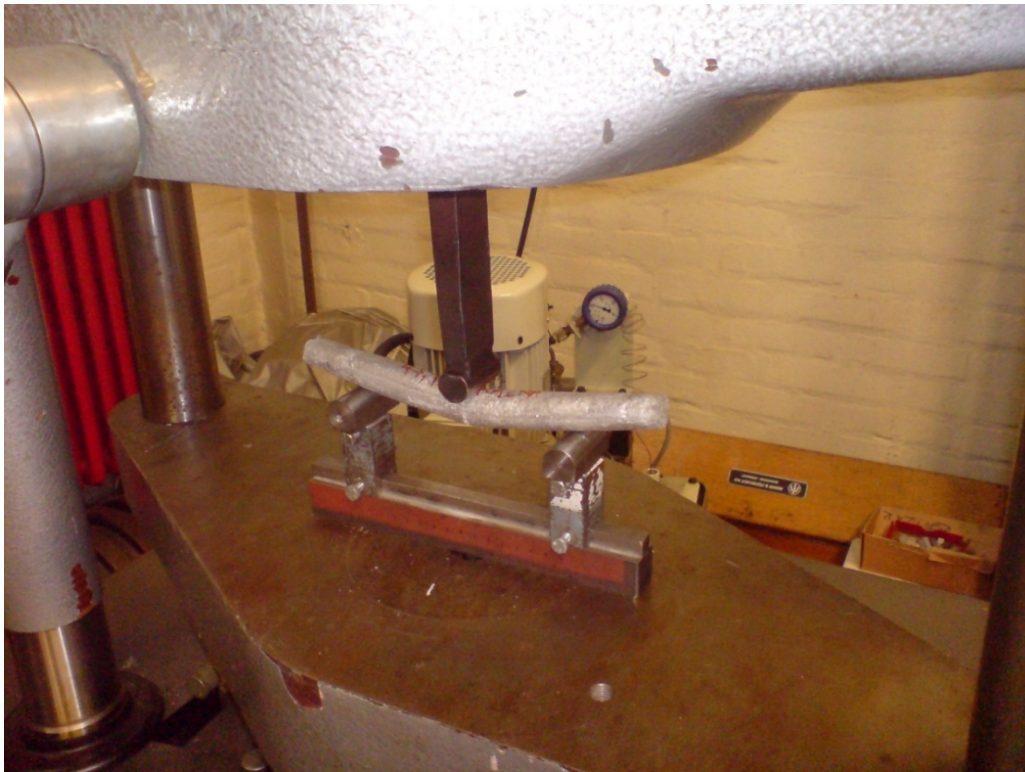
Slika 41. Uzorak za vrijeme ispitivanja
