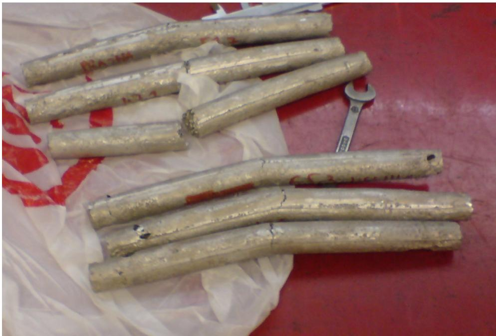
*Slika 43. Uzorci nakon ispitivanja na savijanje*
