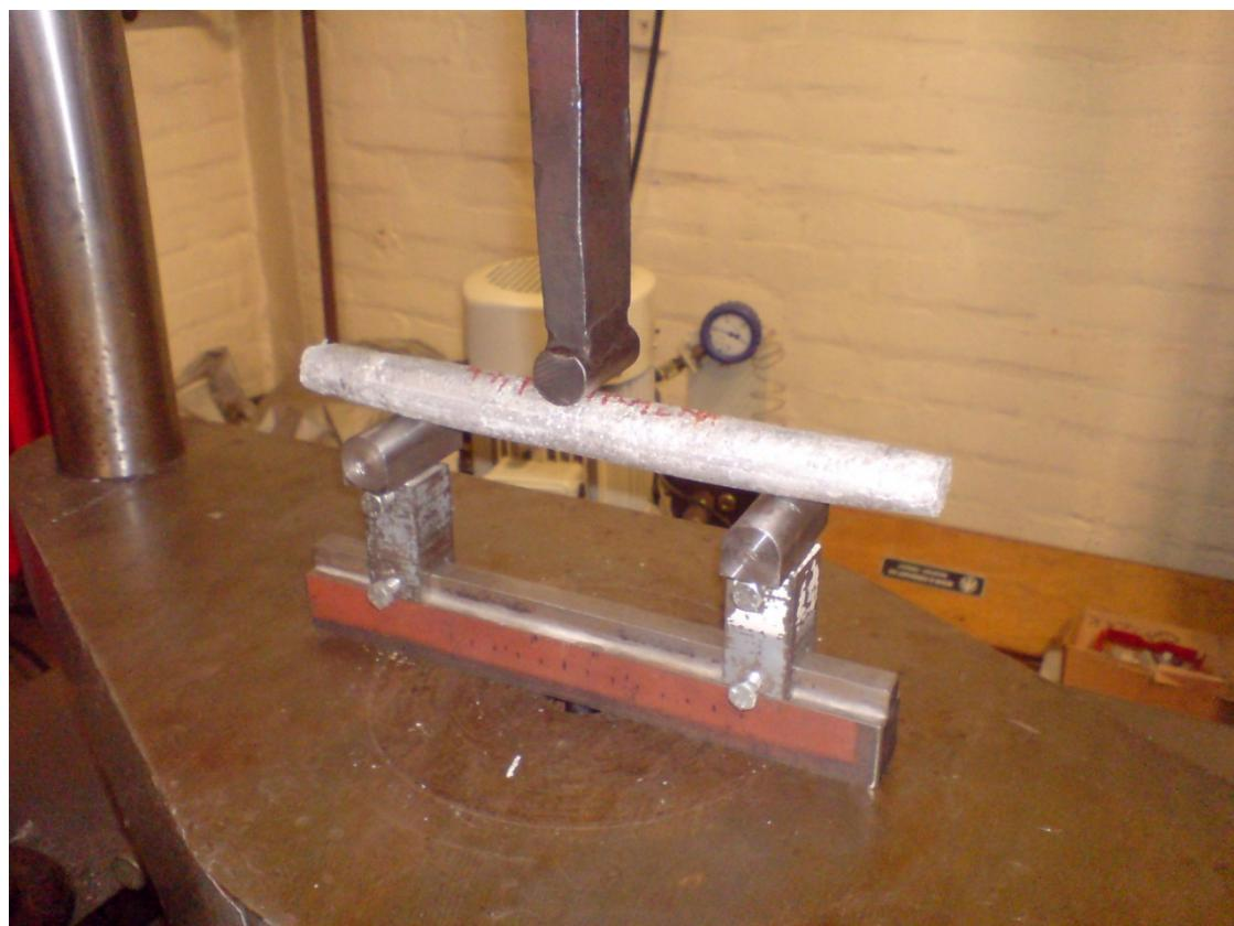
Slika 40. Uzorak na kidalici pripremljen za ispitivanje
