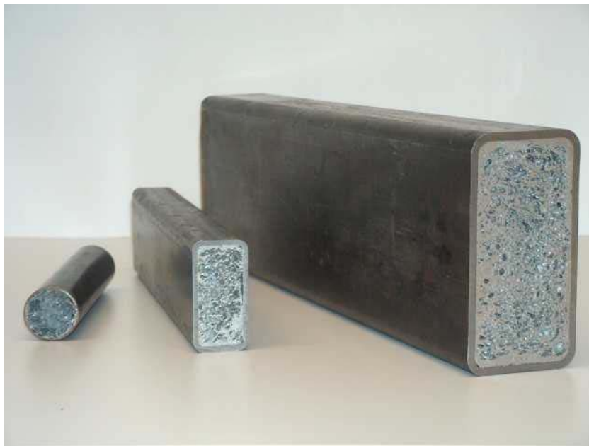
Slika 24. Sendvič konstrukcija s jezgrom od metalne pjene [2]
