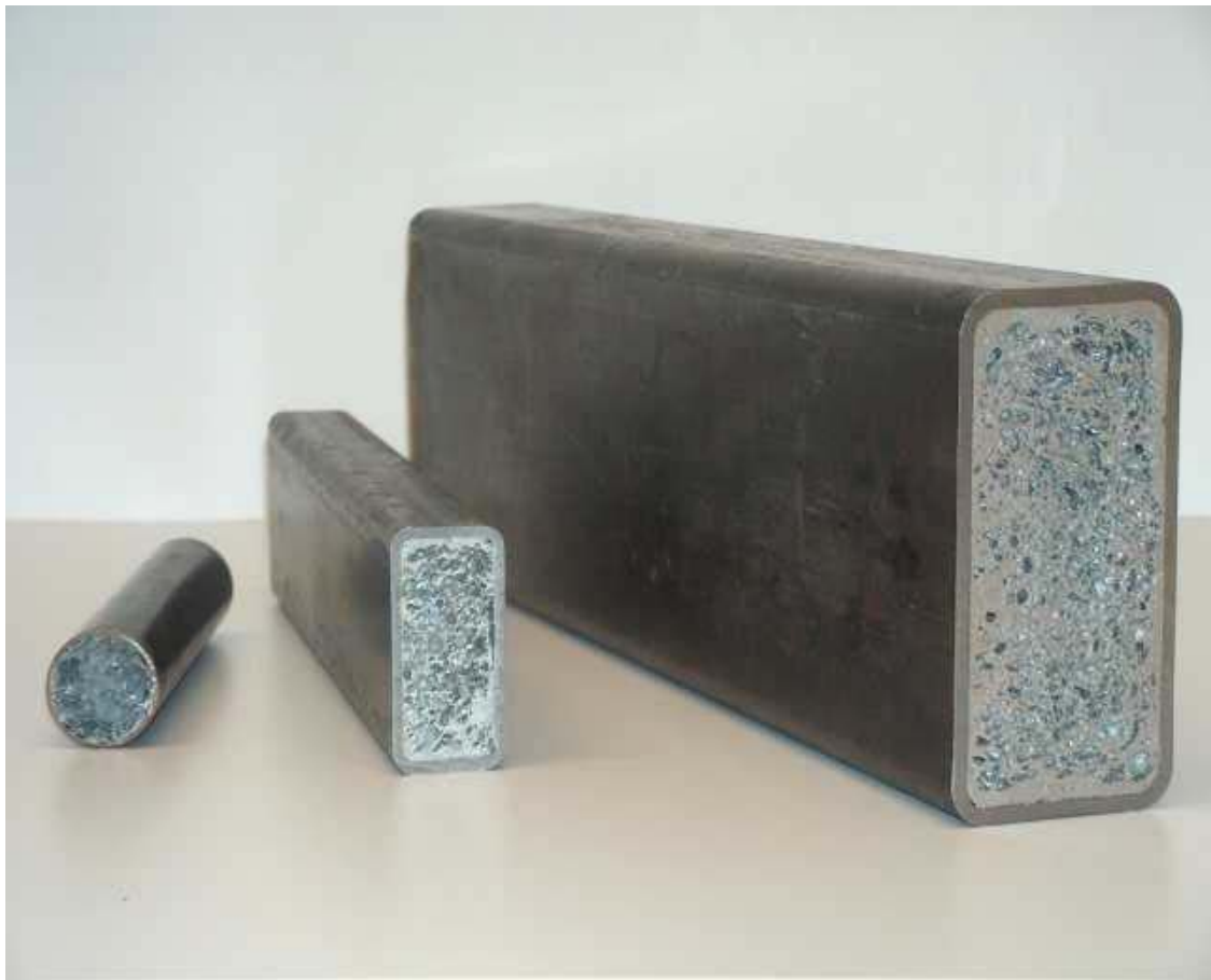
Slika 2. Sendvič konstrukcija s jezgrom od metalne pjene [2]
