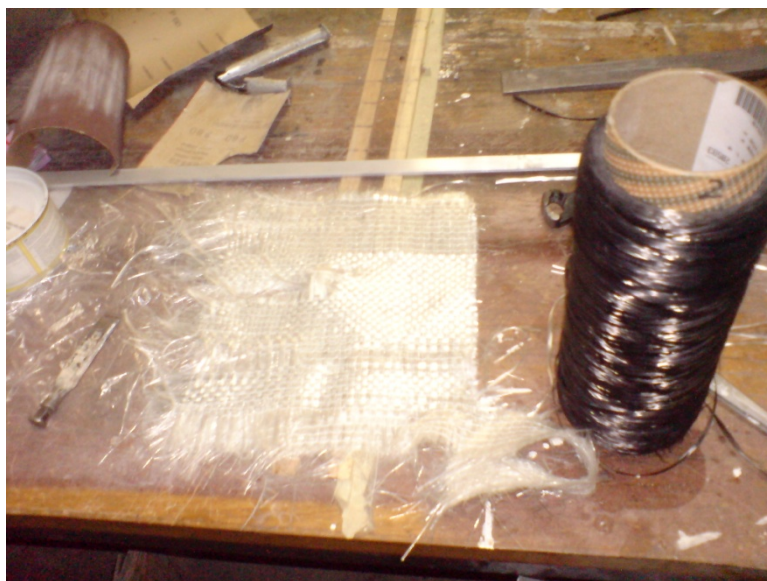
Slika 31. Za ojačalo su korištena komercijalno dostupna staklena i ugljična vlakna
