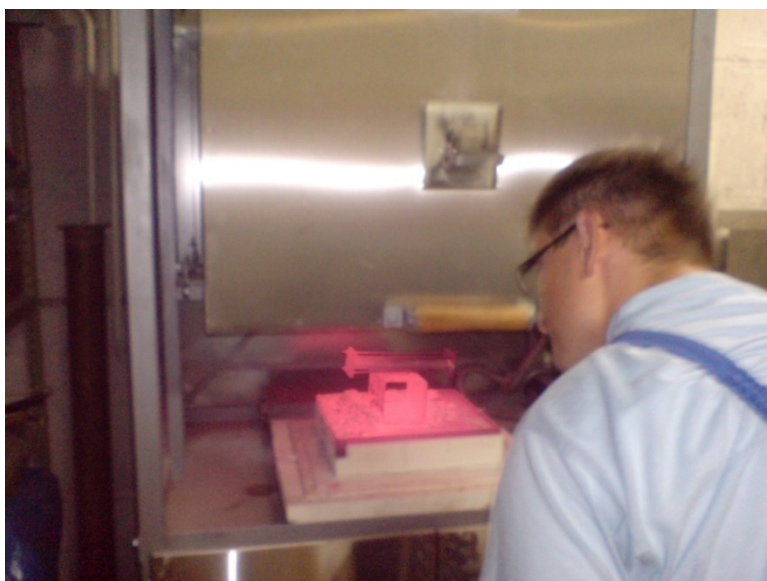
Slika 36. Kalup u peći zagrijanoj na temp. od 790 °C
