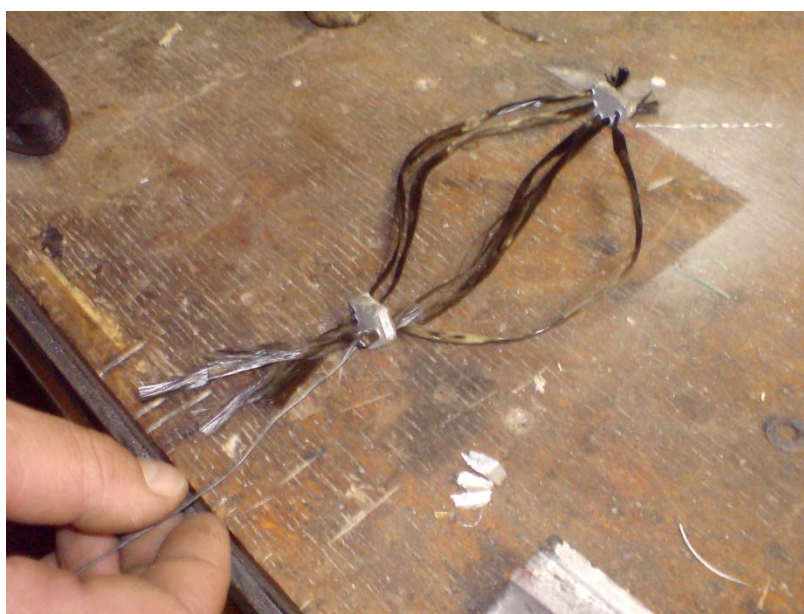
Slika 32. Provlačenje ugljičnih vlakana kroz "usmjerivače" od prekursora
