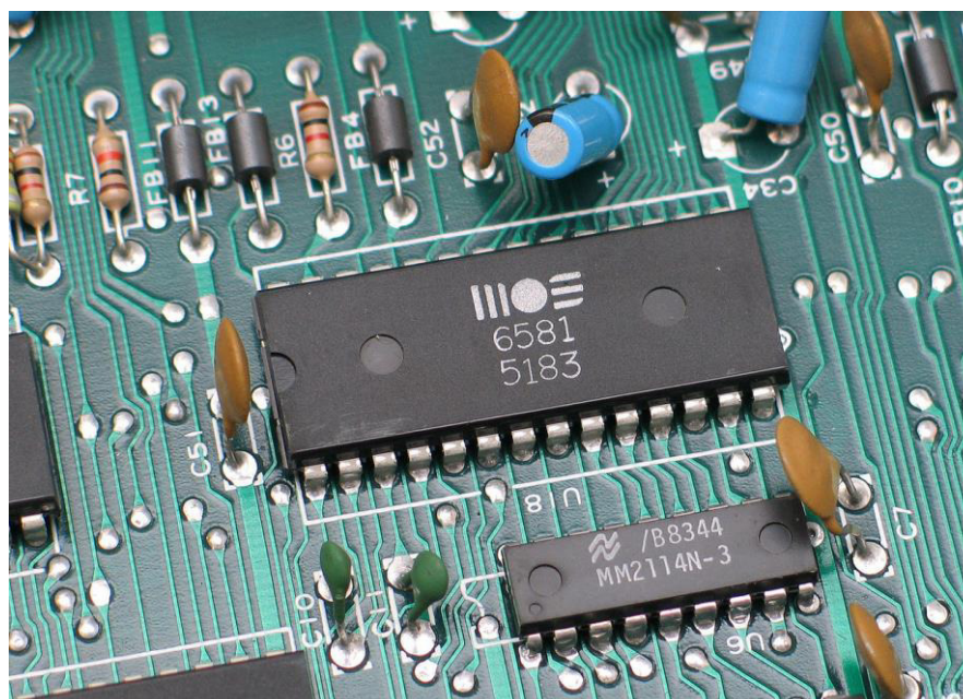
Slika 26. Komponente matične ploče spojene THT lemljenjem
