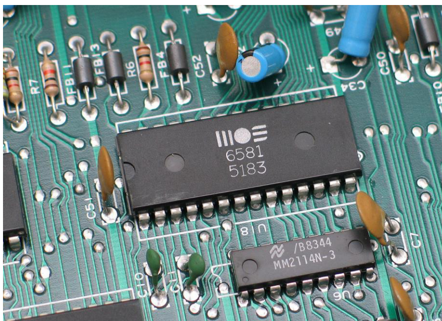
Slika 26. Komponente matične ploče spojene THT lemljenjem
