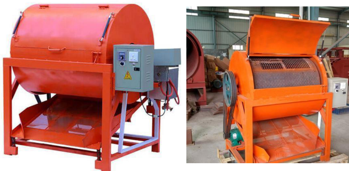
Slika 47. Stroj za uklanjanje komponenti s matičnih ploča
