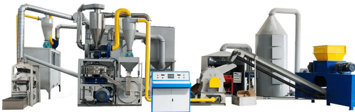
Slika 44. Shema pogona za obradu matičnih ploča
