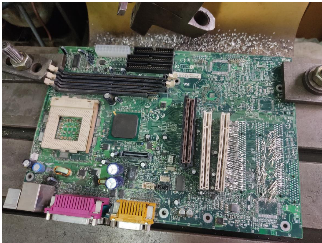
Slika 37. Prihvat ispitne matične ploče
