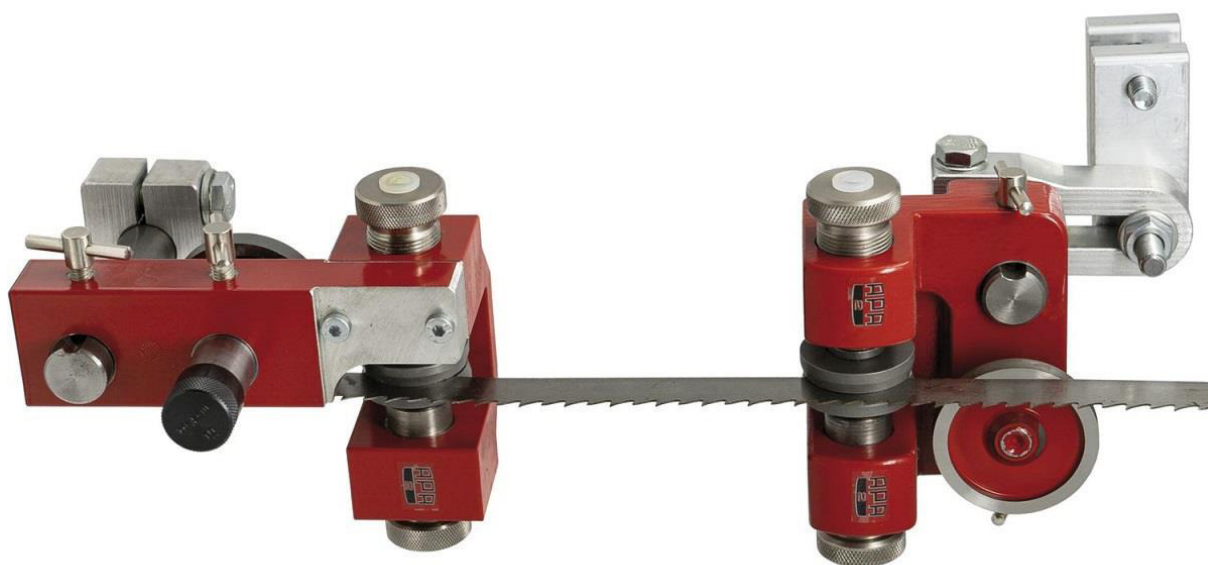
Slika 75. Vodilice lista tračne pile, [12]
