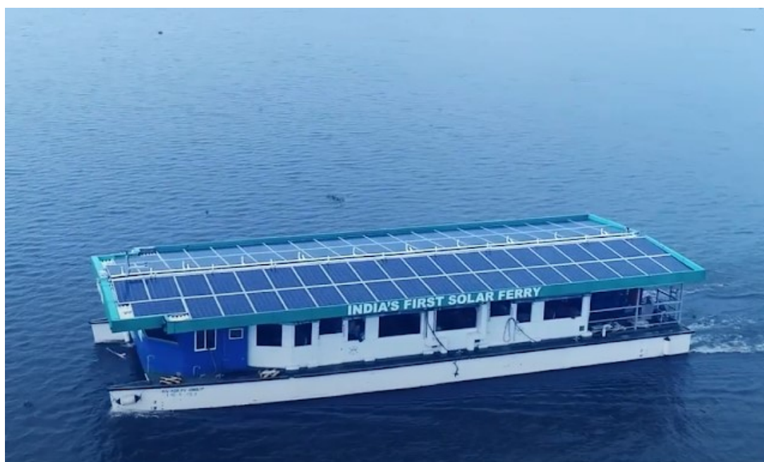
Slika 36. Prvi putnički brod pogonjen isključivo solarnom energijom u Indiji [16]
