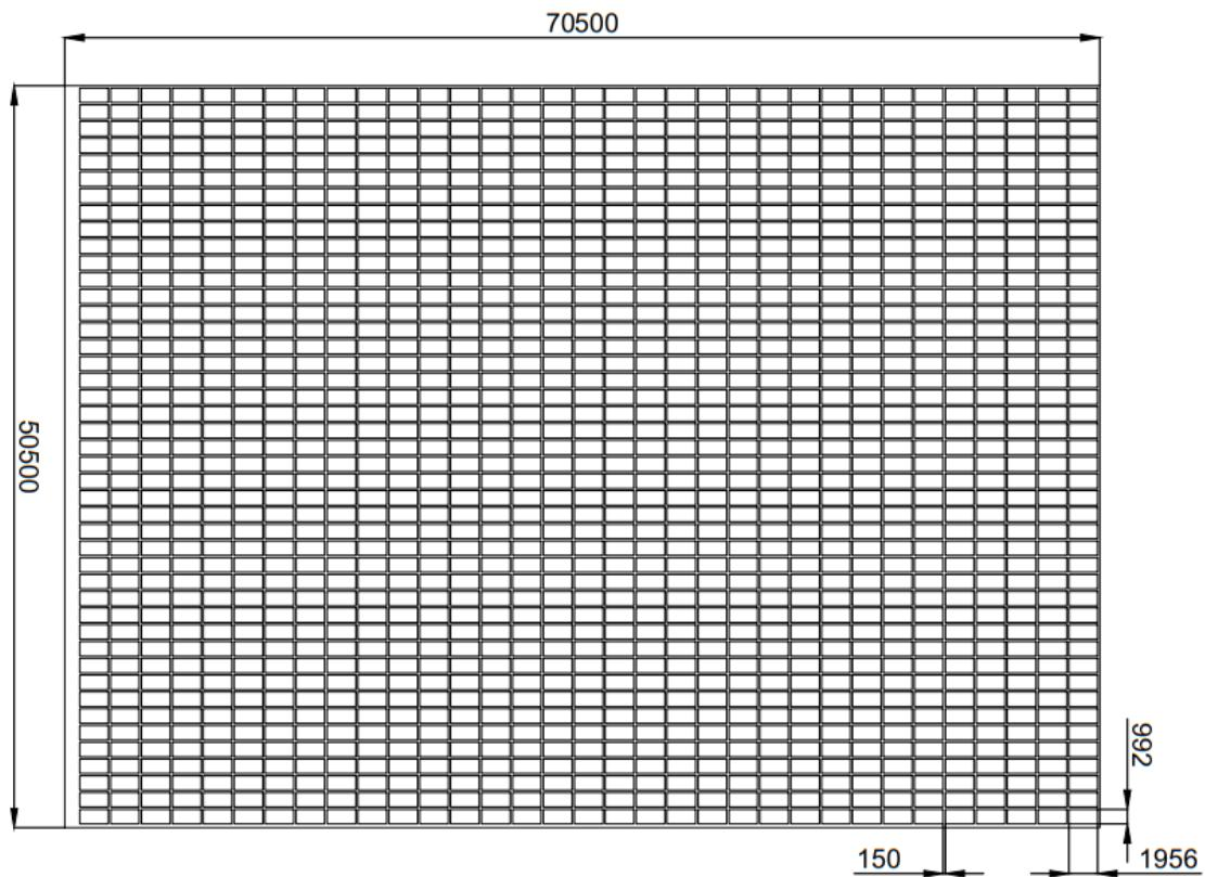
**Slika 37. Raspored fotonaponskih modula na krovu plutajuće garaže**
