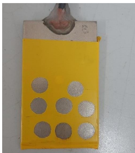
Slika 38. Prikaz svih ispitnih mjesta na čeliku 904L
