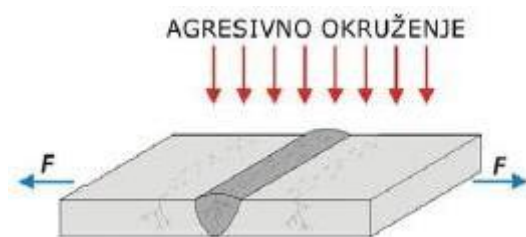
Slika 22. Čimbenici koji uvjetuju nastanak napetosne korozije [36]
