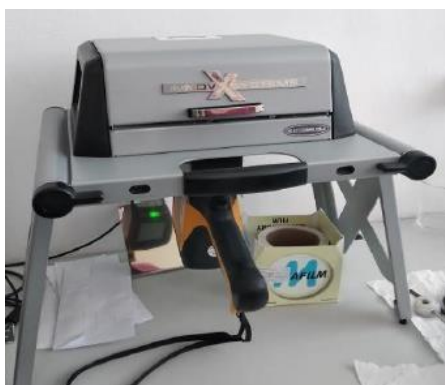
Slika 35. Uređaj XRF Olympus
