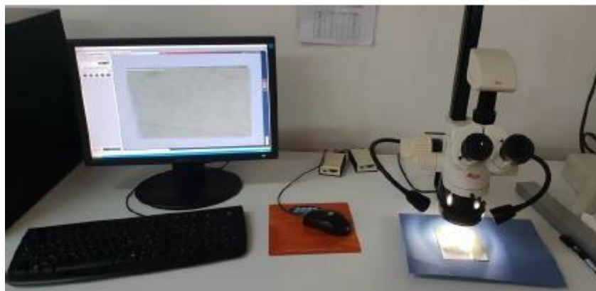
Slika 48. Stereomikroskop Leica MZ6
