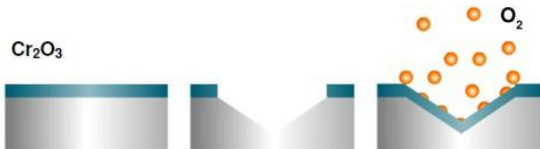
Slika 1. Prikaz mehanizma samoobnavljanja pasivnog filma [6]
