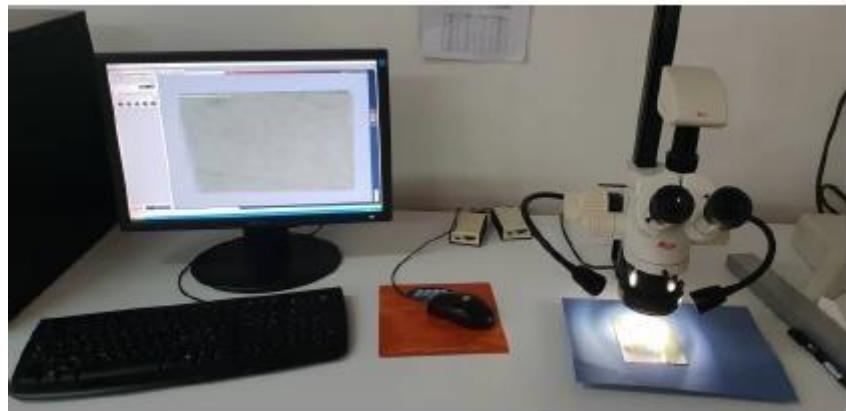
Slika 48. Stereomikroskop Leica MZ6
