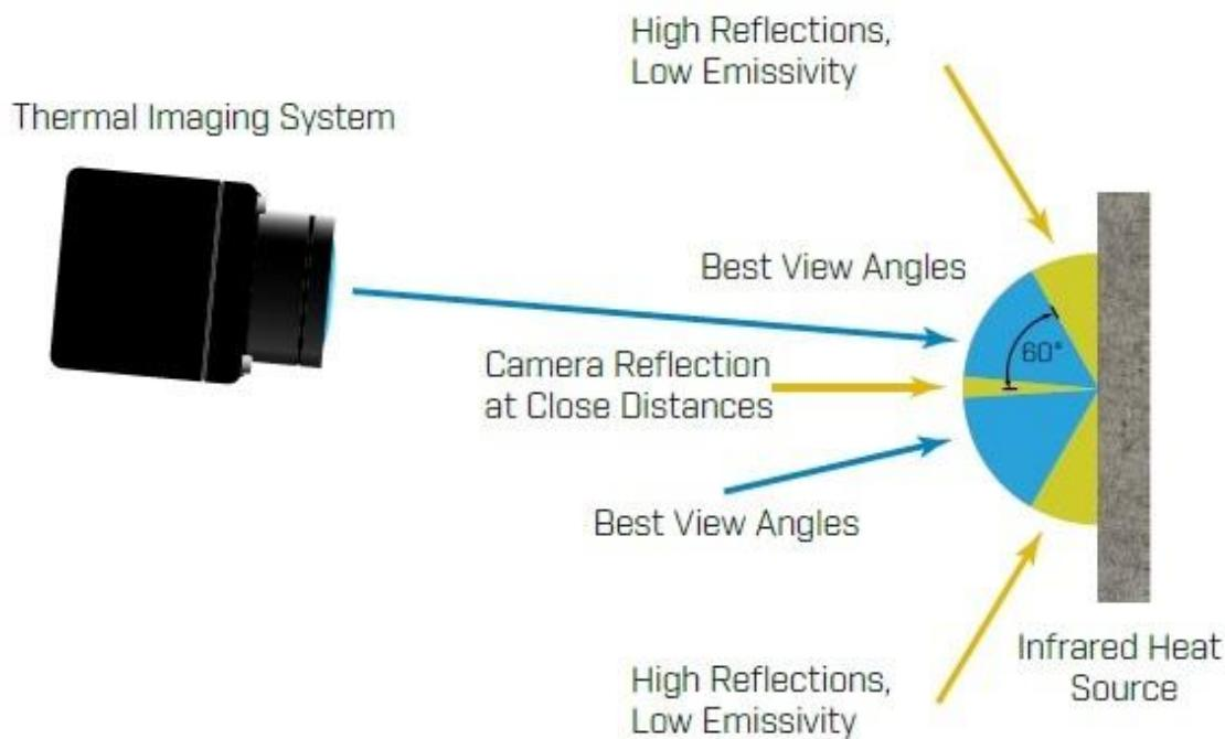
Slika 23. Optimalan kut mjerena IC senzorom [22]
