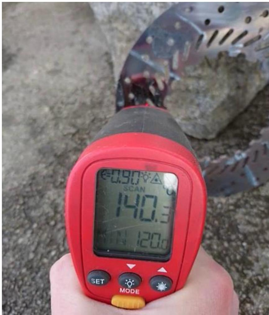
**Slika 48. Mjerenje temperature diska dok se hlađi na mirujućem zraku bez vjetra**
