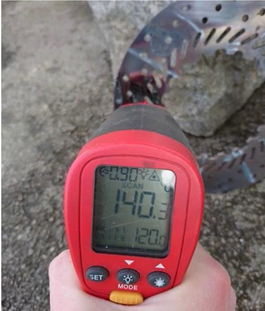
Slika 48. Mjerenje temperature diska dok se hladi na mirujućem zraku bez vjetra
