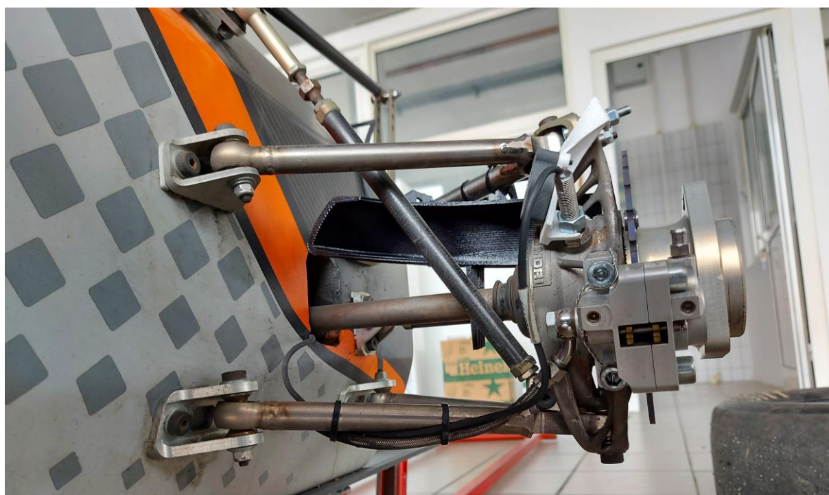
Slika 29. Stražnji sklop kotača s IC senzorom i aerodinamičkim deflektorom za hlađenje diskova
