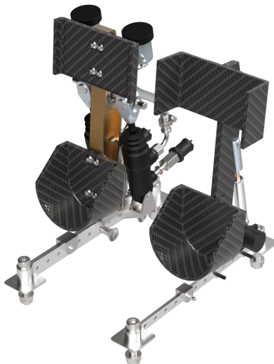
Slika 16. Sklop pedala bolida FSB-RT06R VulpesR -a
