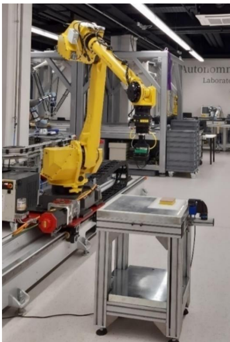
Slika 58. Eksperimentalni postav za ispitivanje točnosti i ponovljivosti Fanuc 3D Area senzora
