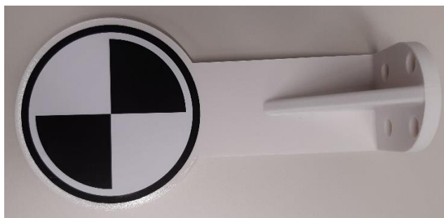
Slika 29. Konačni izgled alata za kalibraciju kamera
