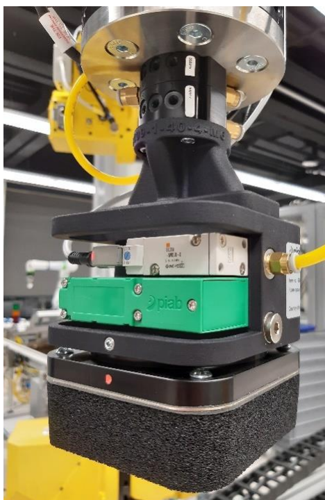
Slika 11. Piab Kenos KCS vakuumska hvataljka
