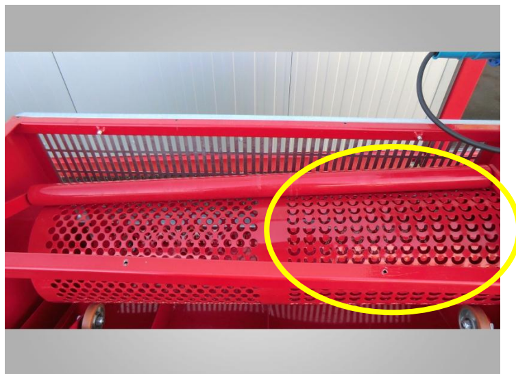
Slika 46 Grubo odvajanje ljuske bubnjem s rupama [17]
