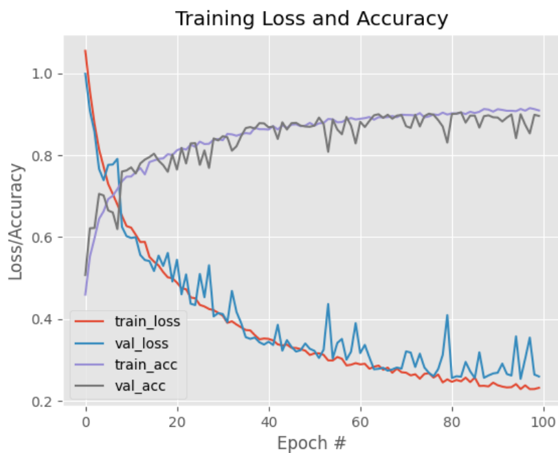
Slika 73 Prikaz funkcije gubitaka i točnosti konvolucijske neuronske mreže s manje slojeva
