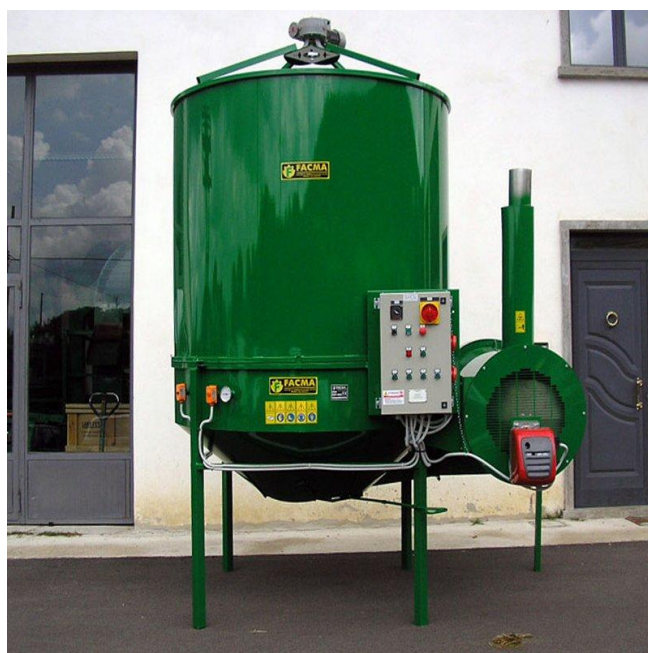
Slika 8 Sušara lješnjaka proizvođača Facma [6]
