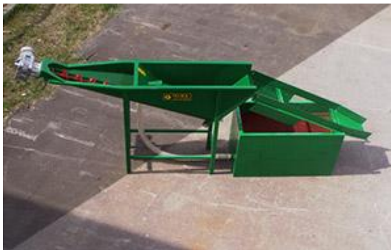
Slika 23 Odvajač zemlje i nečistoća od lješnjaka, proizvođača Facma [6]
