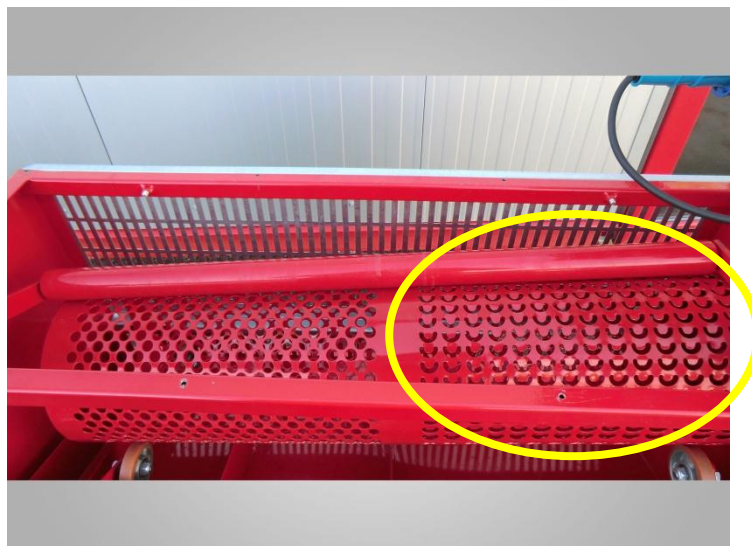
Slika 46 Grubo odvajanje ljuske bubnjem s rupama [17]
