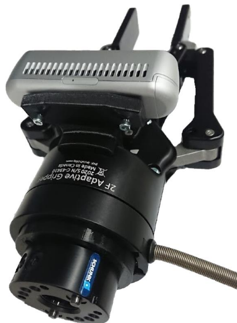
Slika 13. Sklop izmjenjivača alata, hvataljke i 3D vizijskog sustava
