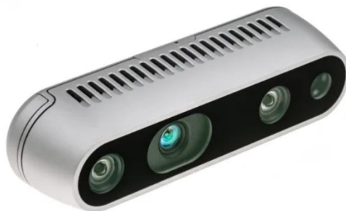
Slika 7. Stereovizijski sustav Intel RealSense D435 [8]
