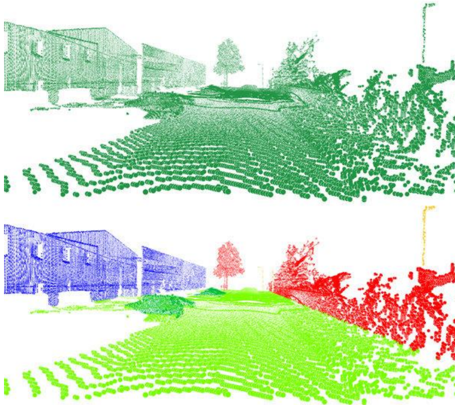
Slika 9. Obrada oblaka točaka [9]
