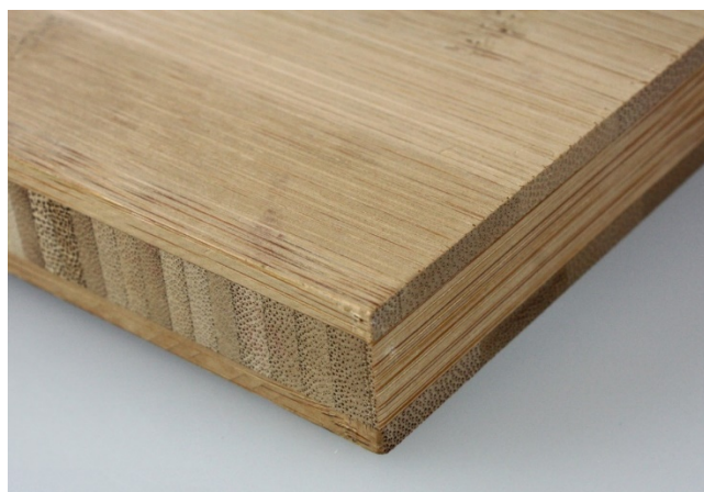
Slika 17. Troslojna ploča od bambusa [24]
