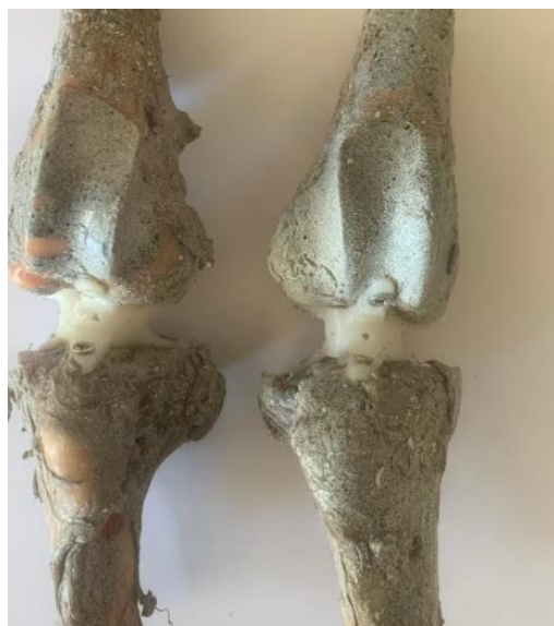
Slika 94. Uzorci koji su pripremljeni za ispitivanje sustavom ARAMIS na kojima se vidi ljuštenje boje
