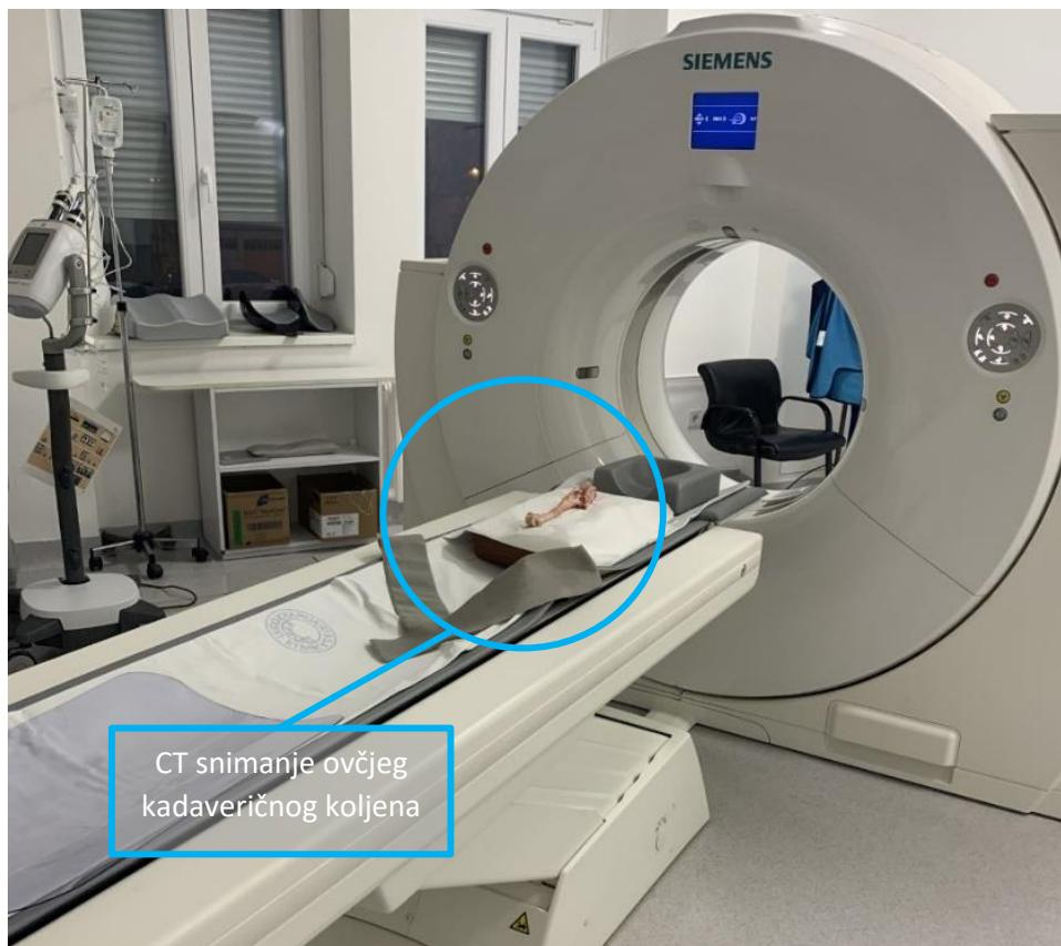
*Slika 48. Snimanje ovčjeg kadaveričnog koljenoga zgloba CT uređajem*
