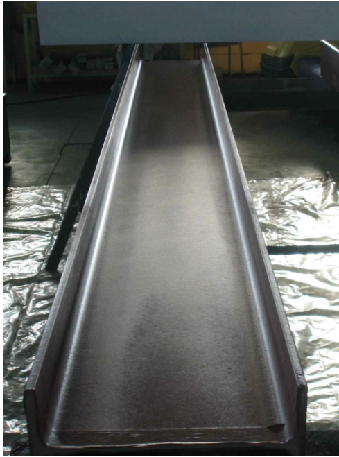
Slika 5. Izgled profila (4.40m) koji se koristi za ispitivanje
