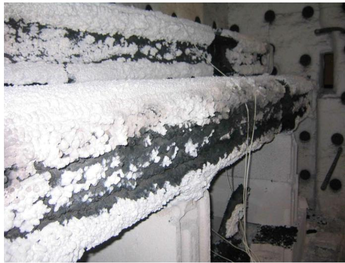
Slika 7. Izgled čeličnih profila nakon hlađenja
