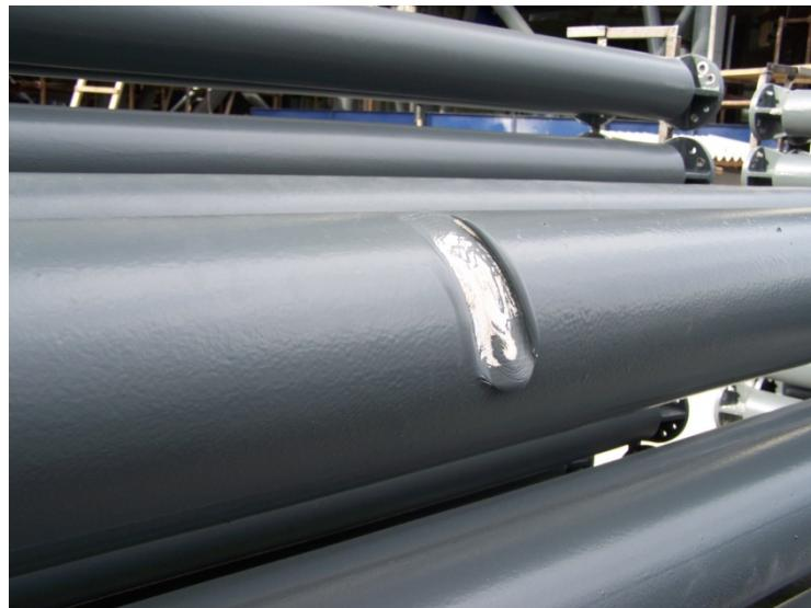
Slika 4. Oštećenje premaza pri transportu
